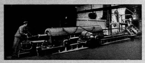
Abb. 2. Fassen des Rohres und Rückwärtsbewegung des Kokillenwagens.
