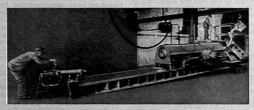
Abb. 1. Anfangsstellung. Der Kokillenwagen befindet sich in seiner oberen Endstellung.
