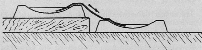
in dem sich die Objekte befinden (Hohlschliff-objektträger, Uhrschale, am besten der in der Abbildung dargestellte Glasklotz mit Hohlschliff, den der Mikrokosmos in Stuttgart, Pfizerstrasse, liefert) einen oben sauber abgeschnittenen Filterpapierstreifen in ein zweites, etwas tiefer stehendes Gefäß. Apparat nicht vergessen, sonst trocknen die Objekte ein. *G.*
