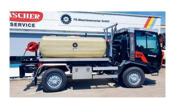
Ein 2300-l-Tankaufbau mit Abrollrahmen für ein Hakengerät auf einem Reform-Transporter für Wasch- und Giessarbeiten.
