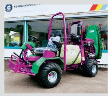
Flaggschiff des FS-Maschinencenters: «Turbomobil 526D-4 561H Bi-Turbo Invers» mit 26-PS-3-Zylinder-Dieselmotor.
