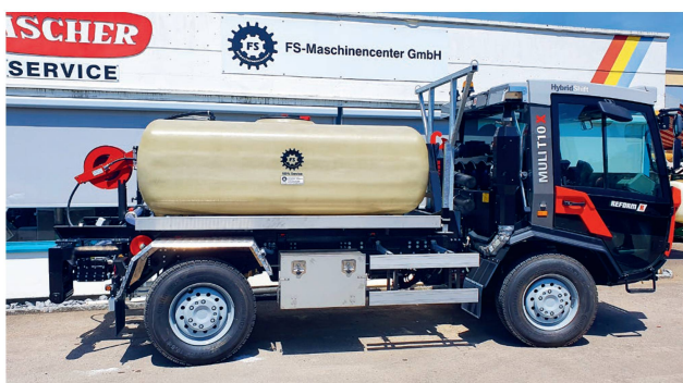
Ein 2300-l-Tankaufbau mit Abrollrahmen für ein Hakengerät auf einem Reform-Transporter für Wasch- und Giessarbeiten.
