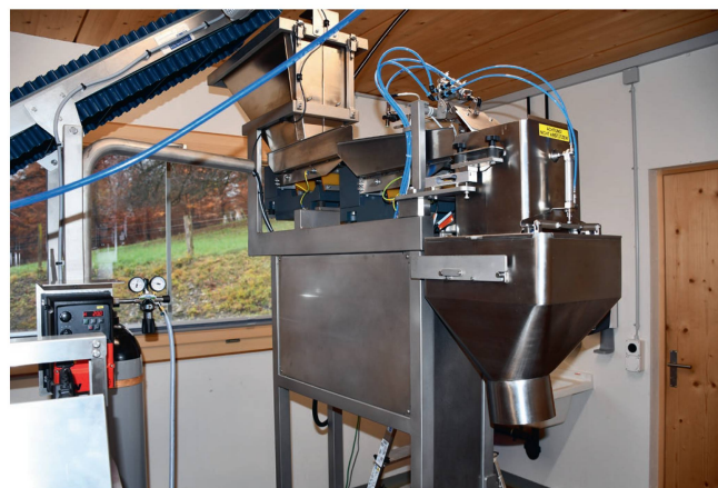
Der letzte Schritt bei der Verarbeitung der Baumnüsse ist die Verpackung, wo die Nusskerne verpackt und vakuumiert lagerfähig gemacht werden.
