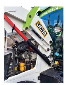
Der neue Wasserstoffmotor passt relativ problemlos ab Werk in diesen Baggerlader «3CX» von ICB. Die Wasserstoffflaschen sind auf der rechten Geräteseite platziert. Bild: JCB
