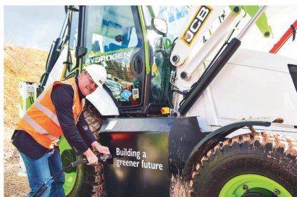
Das Befüllen der Wasserstoffflaschen erfolgt einfach in wenigen Minuten vor Ort über ein einfaches Ventil. Bild: JCB
