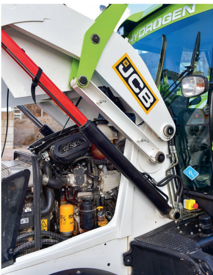
Der neue Wasserstoffmotor passt relativ problemlos ab Werk in diesen Baggerlader «3CX» von JCB. Die Wasserstoffflaschen sind auf der rechten Geräteseite platziert. Bild: JCB
