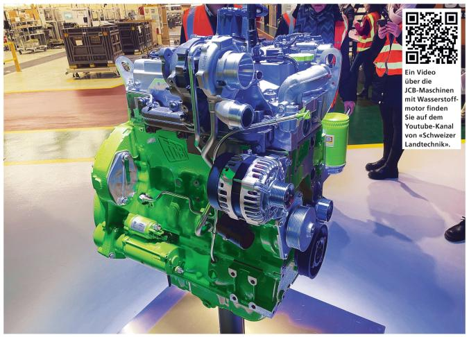
Dieser Wasserstoff-Motor, von dem JCB schon 50 Exemplare im Testeinsatz hat, leistet rund 75 PS und soll auch beim Drehmoment die gleichen Kennwerte wie sein Diesel-Pendant bieten. Bilder: Matthieu Schubnel
