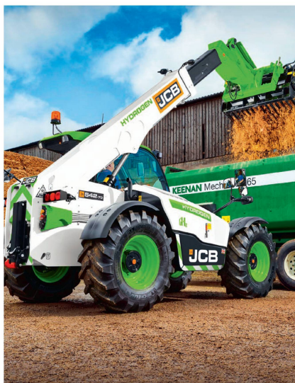
JCB hat den «Zero-emission»-Wasserstoffmotor auch in den Teleskoplader vom Typ «532-70» integriert. Die Wasserstoffreserven befinden sich hier unter dem Kabinenboden. Bild: JCB
