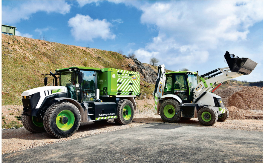
Mit dem Betankungsmodul «Refueler» bietet JCB eine Lösung, um Maschinen auf einer Baustelle mit Wasserstoff zu betanken. Bild: JCB
