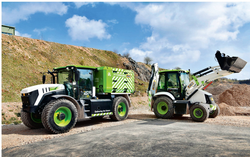
Mit dem Betankungsmodul «Refueler» bietet JCB eine Lösung, um Maschinen auf einer Baustelle mit Wasserstoff zu betanken. Bild: JCB
