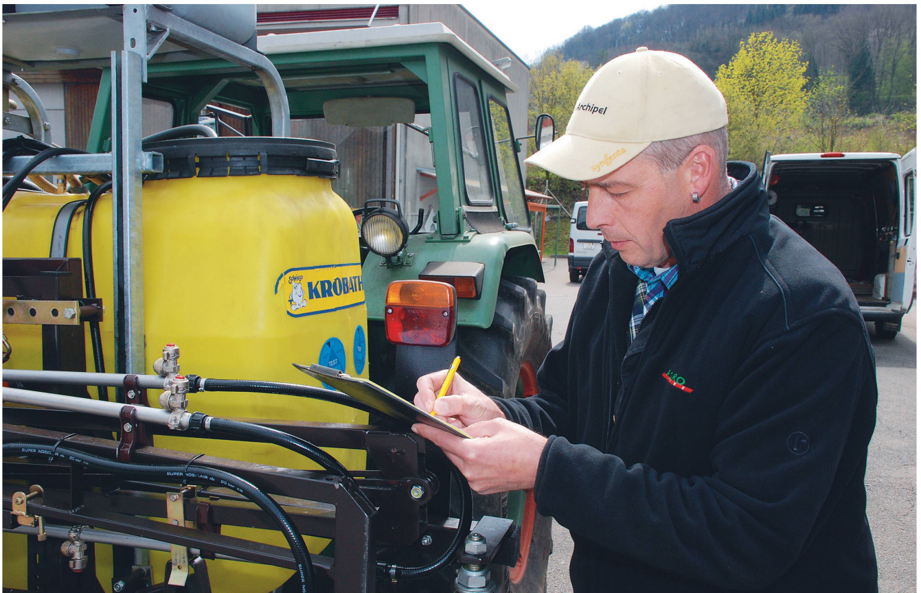
Die für den Pflanzenschutz eingesetzten Spritzen müssen mindestens alle drei Kalenderjahre von einer anerkannten Stelle getestet werden.
