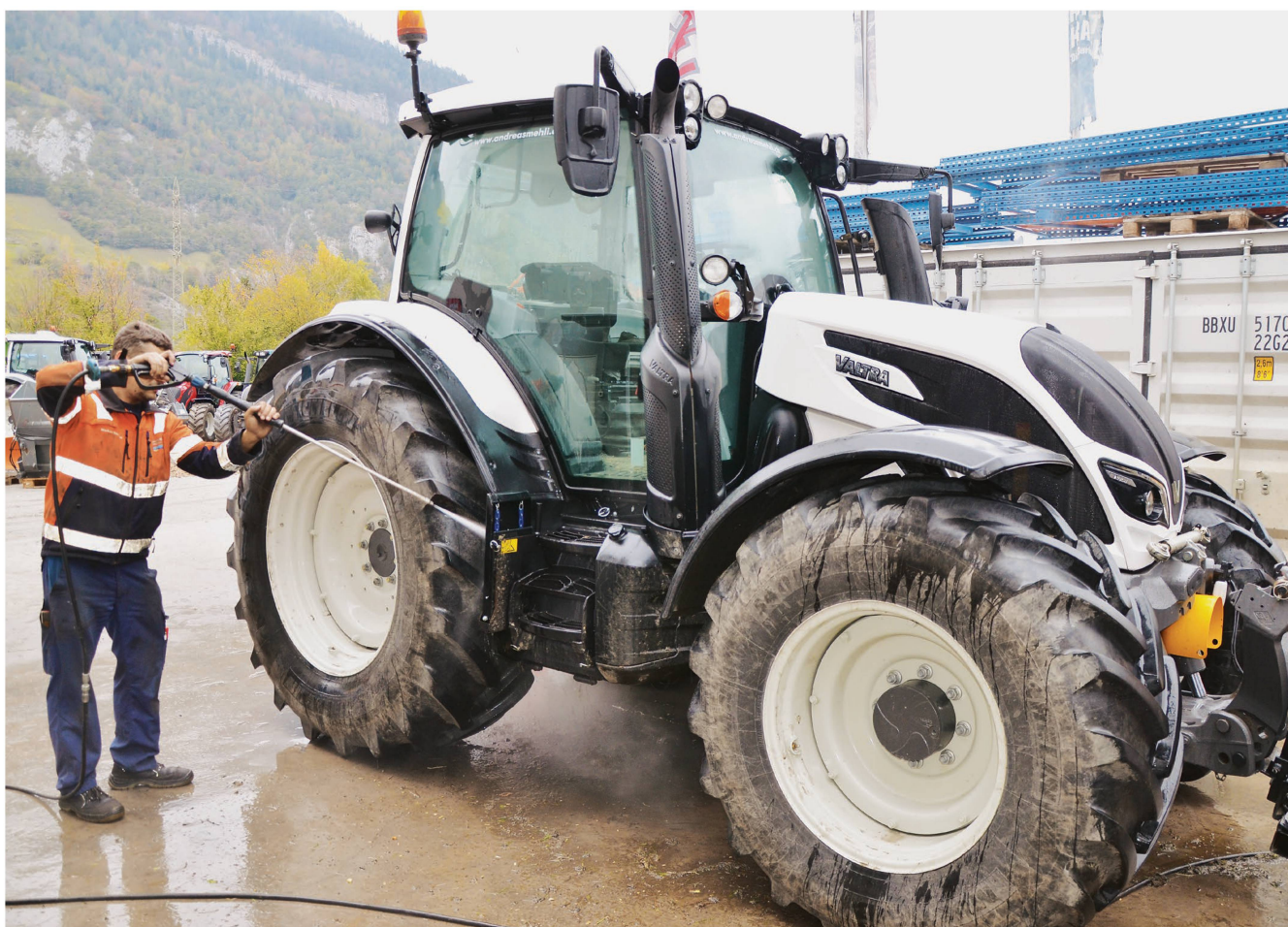
Der Reinigungsplatz für Maschinen und Geräte muss dicht sein und in die Güllegrube entwässert werden. Bild: Kärcher
