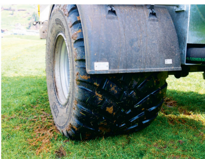
Die Bereifung wurde bewusst breit und bodenschonend in der Dimension «710/45R22.5» gewählt.
