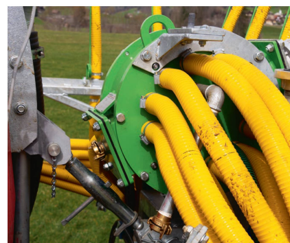
Der Verteilkopf mit 24 Abgängen stammt vom Schweizer Hersteller Hochdorfer.
