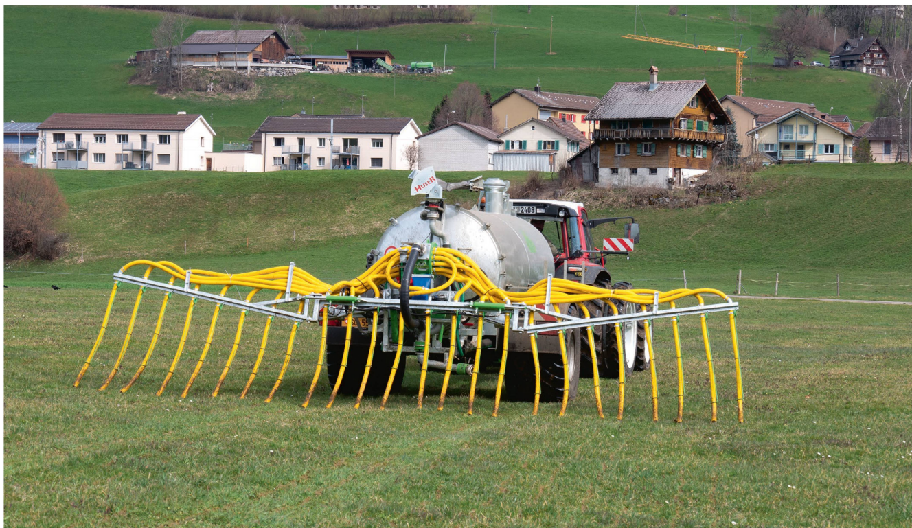
Das Güllefass mit Schleppschlauch «made by Huser» ist mit einem modernen und sicheren Bremssystem ausgestattet. Bilder: Roman Engeler
