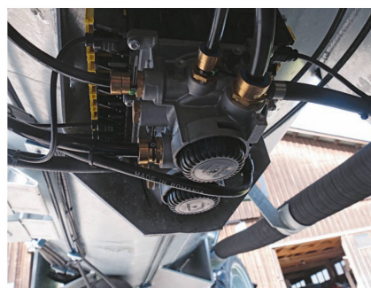
Blick auf die Steuerungseinheit der Multivoltage-Bremsanlage (12/24-V-tauglich), platziert unter dem Fass und vor der Achse.
