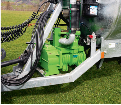
Verbaut ist eine Zentrifugalpumpe des italienischen Produzenten Battioni mit einer Kapazität von 7000 l/min.
