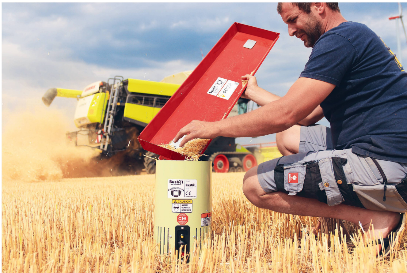
Aus der aufgefangenen Mischung reinigt das Gebläse die Verlustkörner von Spreu und Kurzstroh. Dieses Reinigen per Gebläse ist zwar eine grosse Unterstützung, braucht anfangs aber etwas Übung. Bilder: Lukas Weninger
