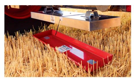
Die Abwurfeinheit (oben) wird per Magnet am Mähdrescher angebracht. Die rote Schale wird mittels Elektromagneten an die Abwurfeinheit gedockt.
