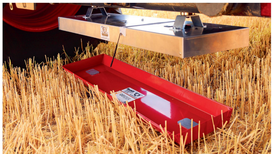
Die Abwurfseinheit (oben) wird per Magnet am Mähdrescher angebracht. Die rote Schale wird mittels Elektromagneten an die Abwurfseinheit gedockt.
