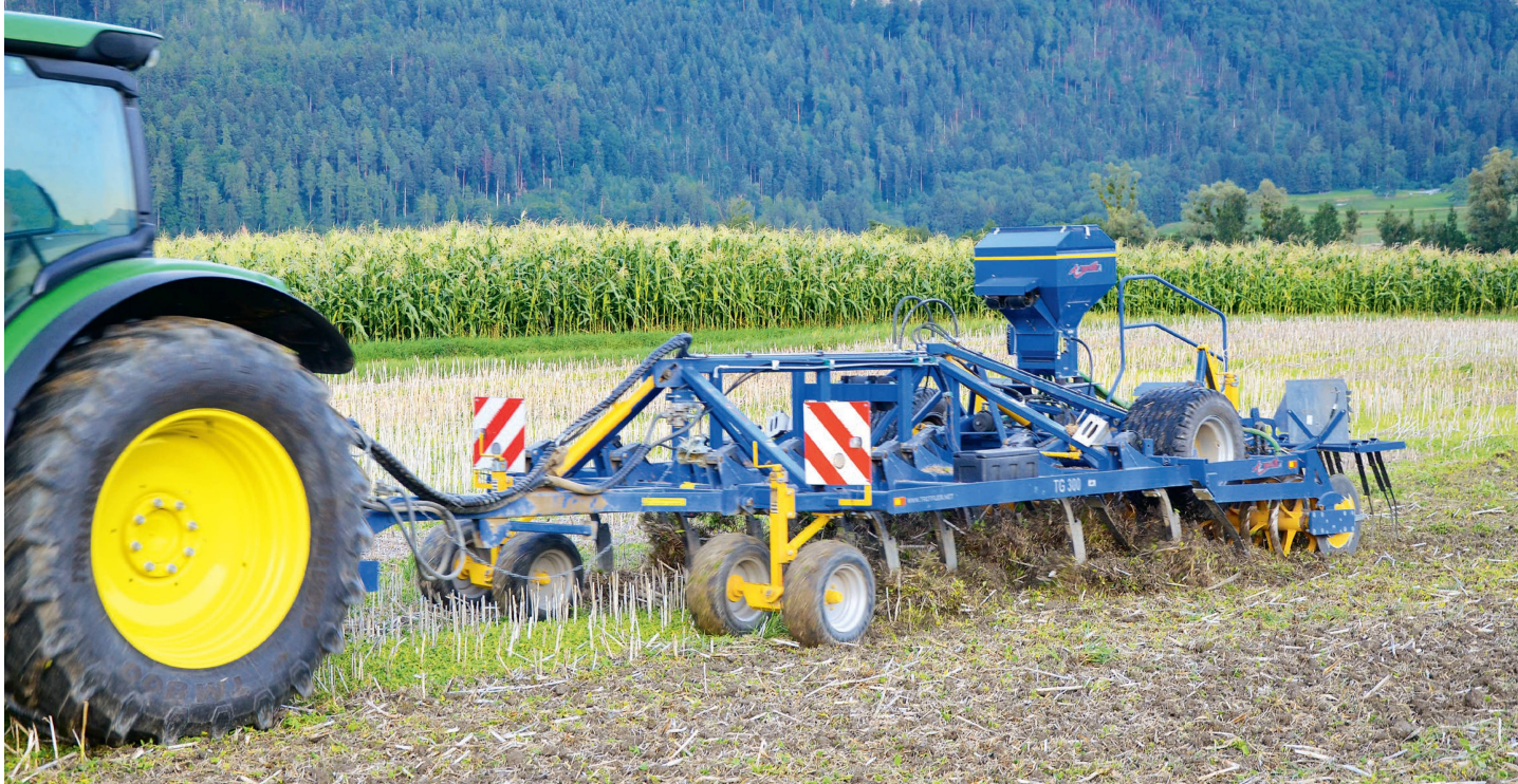
Wenn nur die obersten Zentimeter des Bodens bearbeitet werden, bleibt das Bodengefüge darunter erhalten. Bilder: R. Hunger
