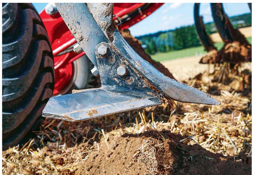
Hartmetallscharen erhöhen die Standzeit, aber auch den Preis. Bild: zvg
