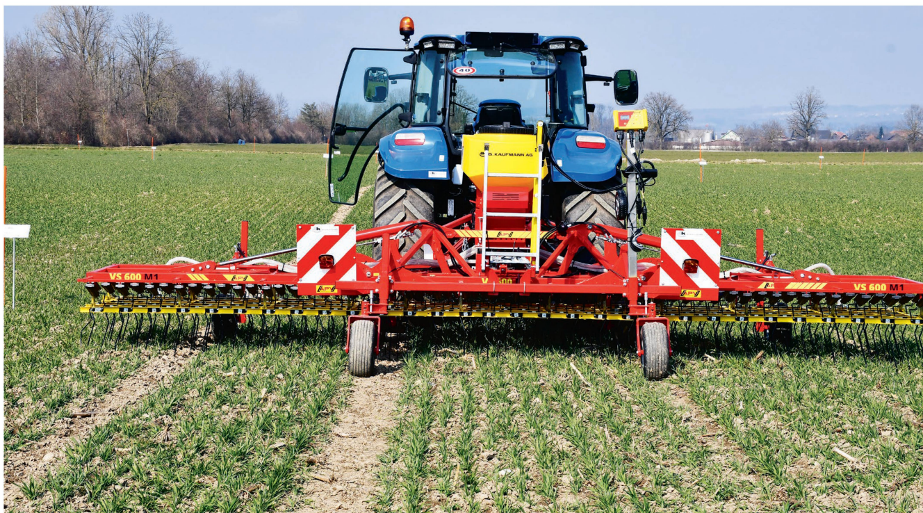
Auch an Striegelzinken entsteht Verschleiss. Da sie keine Fläche aufweisen, werden sie einfach eingekürzt. Bild: Ruedi Hunger
