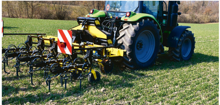
Die Arbeitsqualität verschlechtert sich mit zunehmendem Verschleiss, speziell bei Scharhackgeräten. Bild: Ruedi Hunger
