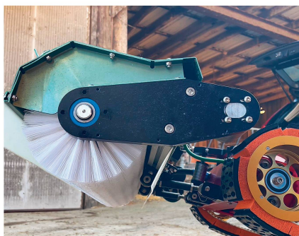
Die beiden Bürsten sind jeweils an drei Punkten am Rahmen befestigt, um eine Querbewegung zu ermöglichen.
