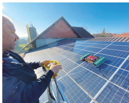
Der mit Lithiumbatterien ausgestattete Solarreiniger läuft rund 4,5 bis 5 Stunden und wird per Fernsteuerung bedient.
