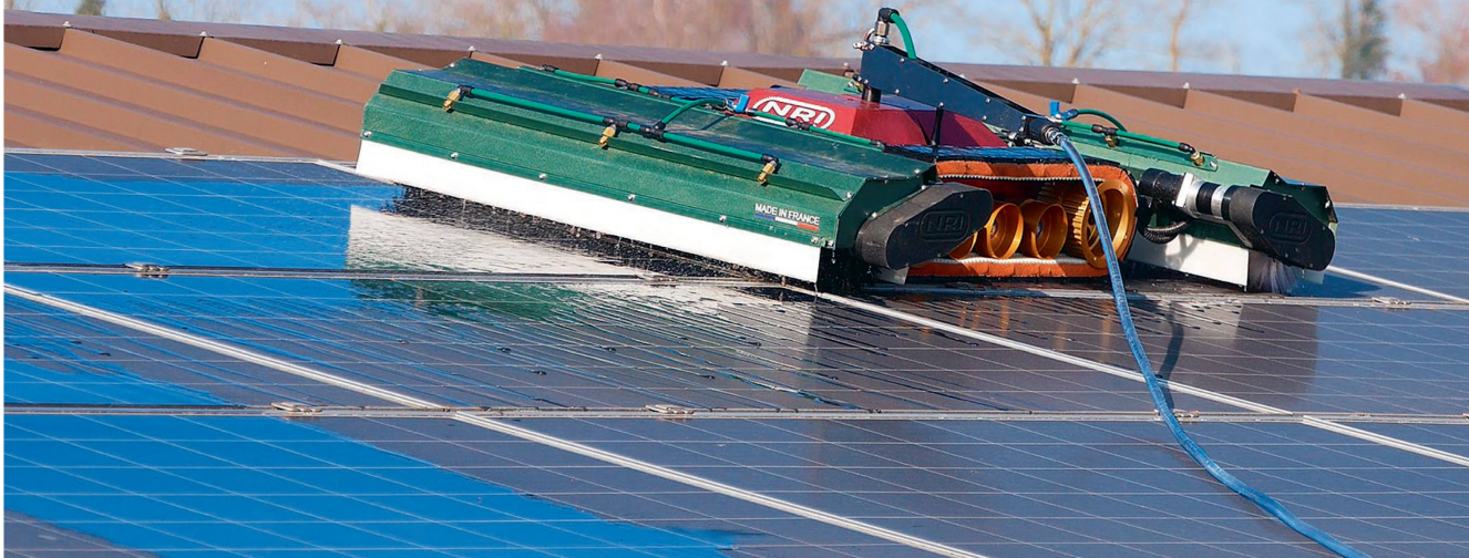
Der Solar-Reinigungsroboter «Opti+5P» des französischen Herstellers NIR bei der Arbeit. Bilder: Matthieu Schubnel
