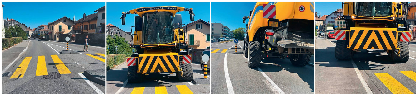
Für den Mähdrescher gibt es an dieser Verengung mit Verkehrsinsel nur eine Möglichkeit. Er muss auf das Trottoir ausweichen und dabei den scharfkantigen und hochstehenden Randstein überfahren, was die Gummiraupen (oder auch Pneus) beschädigen kann. Bilder: Laurent Vernez
