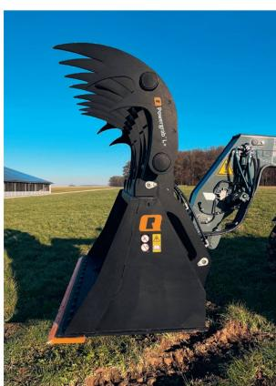
10 t geeignet und kann bis zu 3,3 m<sup>3</sup> Silage in einem Arbeitsgang bei einer Öffnungsweite von 214 cm bewegen. Beide Greifschaufeln sind auf den langfristigen Höchstleistungseinsatz für den Silage-Umschlag in Betrieben mit besonders hoher Silage-Entnahmefrequenz ausgerichtet und helfen, Verluste auf ein Minimum zu reduzieren.
