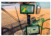
Alternative zum «JDLink R». Es ist eine Plug-and-play Lösung, die eine schnelle und problemlose Konnektivität der gesamten Fahrzeugflotte ermöglicht. Beide Modems sind kompatibel mit dem «SAE J1939»-Protokoll und können über 14 Datenpunkte von unterschiedlichen Maschinenherstellern verarbeiten. Das ermöglicht die Verwaltung der gesamten Fahrzeugflotte in nur einem Portal: dem John Deere «Operations Center».
