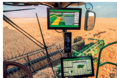
Alternative zum «JDLink R». Es ist eine Plug-and-play Lösung, die eine schnelle und problemlose Konnektivität der gesamten Fahrzeugflotte ermöglicht. Beide Modems sind kompatibel mit dem «SAE J1939»-Protokoll und können über 14 Datenpunkte von unterschiedlichen Maschinenherstellern verarbeiten. Das ermöglicht die Verwaltung der gesamten Fahrzeugflotte in nur einem Portal: dem John Deere «Operations Center».
