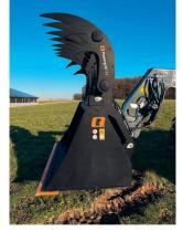
ge in einem Arbeitsgang umschlagen. «Powergrab XL+» ist für Teleskop- und Radlager mit einer Hubkraft von 5 bis 10 t geeignet und kann bis zu 3,3 m³ Silage in einem Arbeitsgang bei einer Öffnungsweite von 214 cm bewegen. Beide Greifschaufeln sind auf den langfristigen Höchstleistungseinsatz für den Silage-Umschlag in Betrieben mit besonders hoher Silage-Entnahmefrequenz ausgerichtet und helfen, Verluste auf ein Minimum zu reduzieren.
