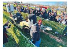
men modularen Werkzeugträger namens «POM». Ausgestattet mit Zwei- oder Allradantrieb kann er zwischen 5 und 10 Stunden bei einer Ladezeit von eineinhalb Stunden arbeiten. Dieses Modell ist an der Vorderseite mit einem mehrschichtigen Lidar für die Personenerkennung ausgestattet.
