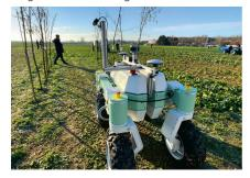
wurde für Gärtnereien oder Baumschulen entwickelt, um den Durchmesser von Sträuchern regelmässig zu überprüfen. Während des Durchgangs misst eine an einem Mast befestigte Kamera mit einer Genauigkeit von 3 mm den Querschnitt jedes Stammes. Das 250 kg schwere Gerät verfügt über eine beidseitige Zentralachs-Differenzialfederung, wodurch die Räder immer Bodenkontakt haben. Es bewegt sich mit einer Höchstgeschwindigkeit von 5 km/h und navigiert mit RTK-GPS und einem Lidar-System.
