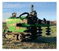
Bohrer am Heckhubwerk ausgestattet. In vordefinierten Abständen werden Löcher mit einem Durchmesser von 10 bis 40 cm in einer maximalen Tiefe von 40 cm gebohrt. Der Roboter bewegt sich mit einer Geschwindigkeit von 3 bis 5 km/h. Er orientiert sich mit zwei GPS-Antennen mit RTK-Korrektur und mimt ein Lidar-System. Der 30-l-Dieseltank gewährleistet eine Autonomie von 8 bis 10 Stunden.
