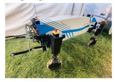
GNSS-Empfänger. Die Räder können einzeln um 360° gedreht werden. Die Lenkung wird mit 3D-Kameras unterstützt. Dank Teleskopachsen lässt sich die Breite von 1,2 bis 1,6 m einstellen. Das hydraulische Fahrwerk kann eine Bodenfreiheit bis zu 1.5 m manuell oder automatisch anpassen. Die Einsatzzeit beträgt rund vier Stunden.
