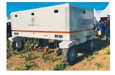
Stunden. Sie können per Kabel aufgeladen oder in wenigen Minuten ausgetauscht werden. Solarmodule im oberen Teil helfen beim Auflade-Vorgang. Eine 90°-Drehung der Räder bringt ihn in die Transportstellung, so dass die Gesamtbreite bei 1,80 m liegt.
