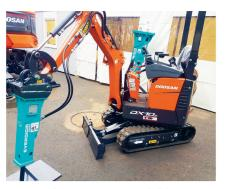
Doosan-Kleinbagger mit Presslufthammer.
