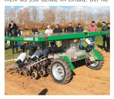
boter wurde für das Säen und mechanische Jäten von Reihenkulturen entwickelt. Dieses vollelektrische Gerät wiegt 900 kg und ist mit einem grossen Solarpanel bestückt, das die auf der Rückseite gelagerten Batterien auflädt. Das Gerät ist für den alleinigen Einsatz im Feld zugelassen. Das Tempo beträgt knapp 1 km/h. Der «FD20» orientiert sich ausschliesslich über RTK-GPS und verfügt über einen peripheren Draht, der bei zunehmender Spannung einen Notstopp auslöst.
