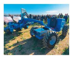
draulikpumpe treibt die Lenkzylinder und das Hubwerk auf Geräteebene an. Dieses Modell war bei der Demonstration mit einer dreireihigen pneumatischen Scheibensämaschine von Monosem ausgestattet. Die Vermarktung des «Softi Rover e-K18» ist in etwa fünf Jahren geplant. Zuvor soll die Maschine mit verschiedenen Anbaugeräten von Drittanbietern ausführlich getestet werden.
