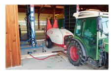
Ab 1. April 2023 ist ein System zur Innenreinigung der Spritze für alle für den Pflanzenschutz eingesetzten Geräte mit einem Behälter von mehr als 400 Litern Inhalt obligatorisch. Bild: zvg
