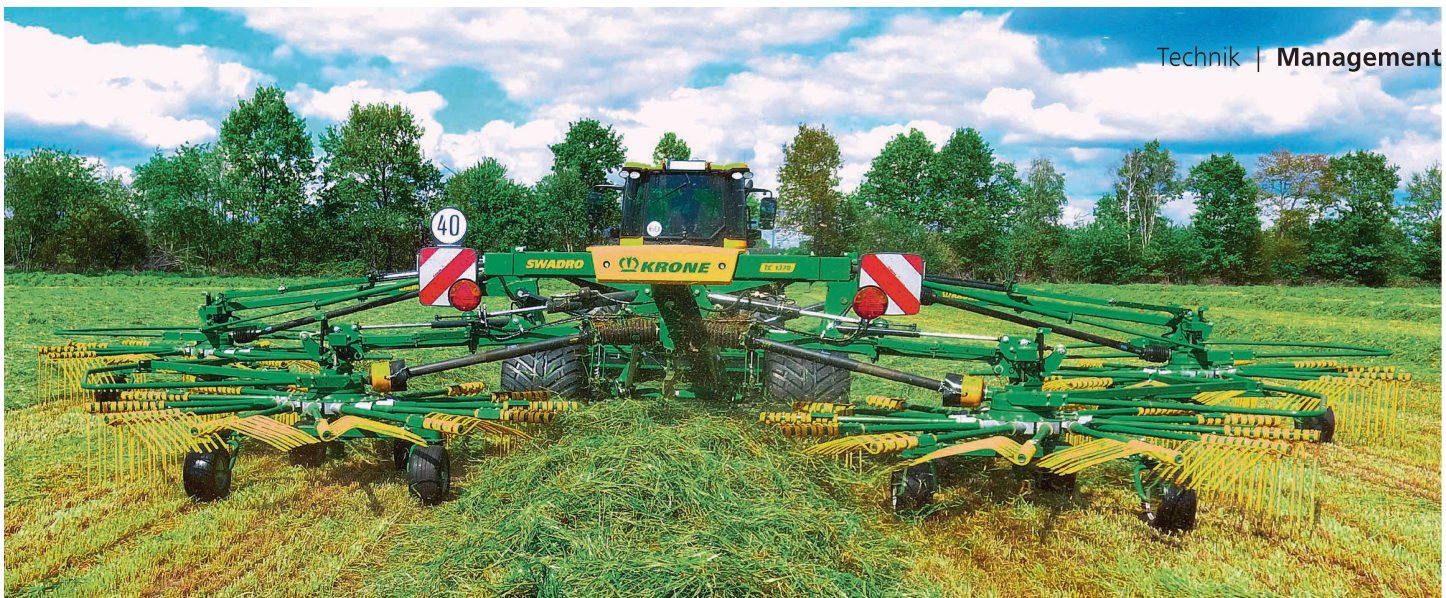
Da Krone beim «Swadro TC1370» einen hohen Volumendurchsatz ohne Abweichung in der Teilgenauigkeit erzielen wollte, nutzt das Unternehmen bei dieser Maschine einen Stromteiler von Power-Hydraulik. Bild: Krone
