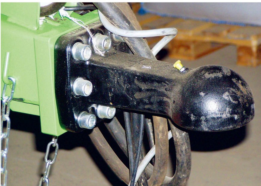
Bei Verschraubungen an Anhänger-Kupplungen dürfen keine Kompromisse eingegangen werden. Bild: Ruedi Hunger
