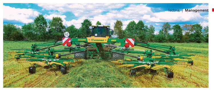
Da Krone beim «Swadro TC1370» einen hohen Volumendurchsatz ohne Abweichung in der Teilgenauigkeit erzielen wollte, nutzt das Unternehmen bei dieser Maschine einen Stromteiler von Power-Hydraulik. Bild: Krone
