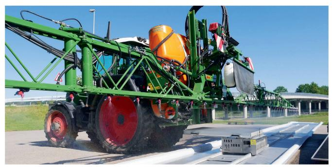
Mit der Zapfwelle angetriebene oder selbstfahrende Feldspritzen müssen alle drei Jahre von einer anerkannten Prüfstelle getestet werden.
