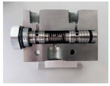
Beim Stromteiler/-vereiniger handelt es sich um ein federbelastetes Ventil in Schieberbauweise. Es teilt einen eingehenden Ölstrom in einem fest vorgegebenen Verhältnis, gleich oder proportional, lastunabhängig in zwei Teilströme auf. Bild: Power-Hydraulik
