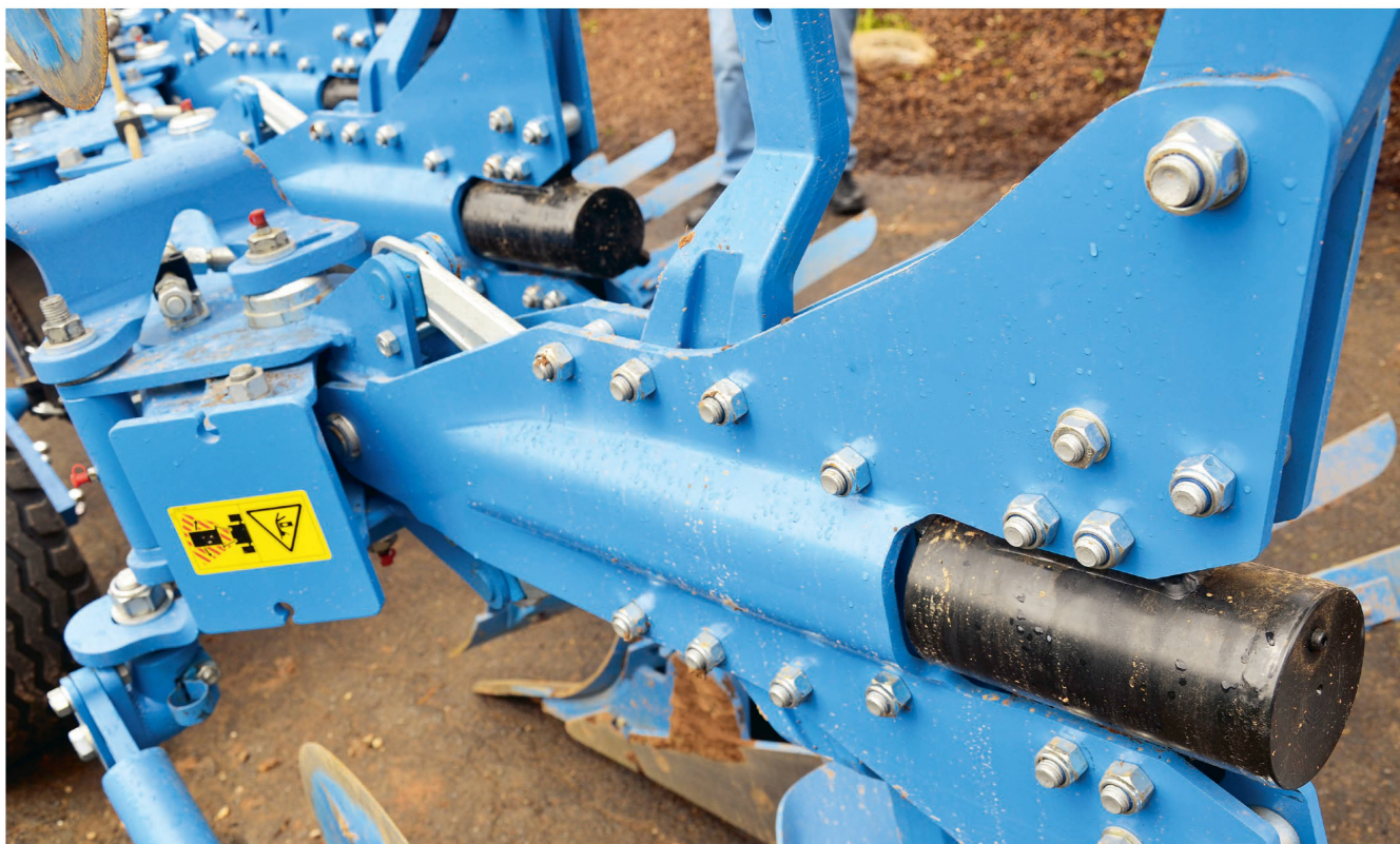
Jede Schraube ist auf die möglichen Belastungswerte dimensioniert. Bild: Ruedi Hunger
