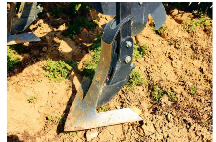
In Serie gibt es ein Schnellwechselsystem für eine Vielzahl an Scharvarianten.
