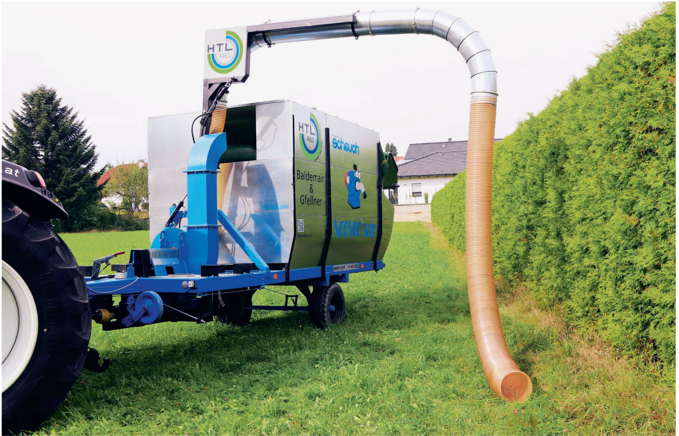
Der Ausleger des Sauggeräts kann über Hecken mit bis zu 3,5 Meter Höhe geschwenkt werden und lässt sich über eine Fernbedienung oder direkt an der Maschine steuern. Bild: Lukas Weninger
