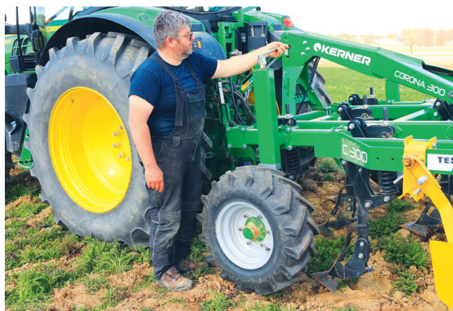
Die optionalen Stützräder verbessern die Tiefenführung. Zum Einstellen muss man vom Traktor absteigen und um das Gerät laufen.
