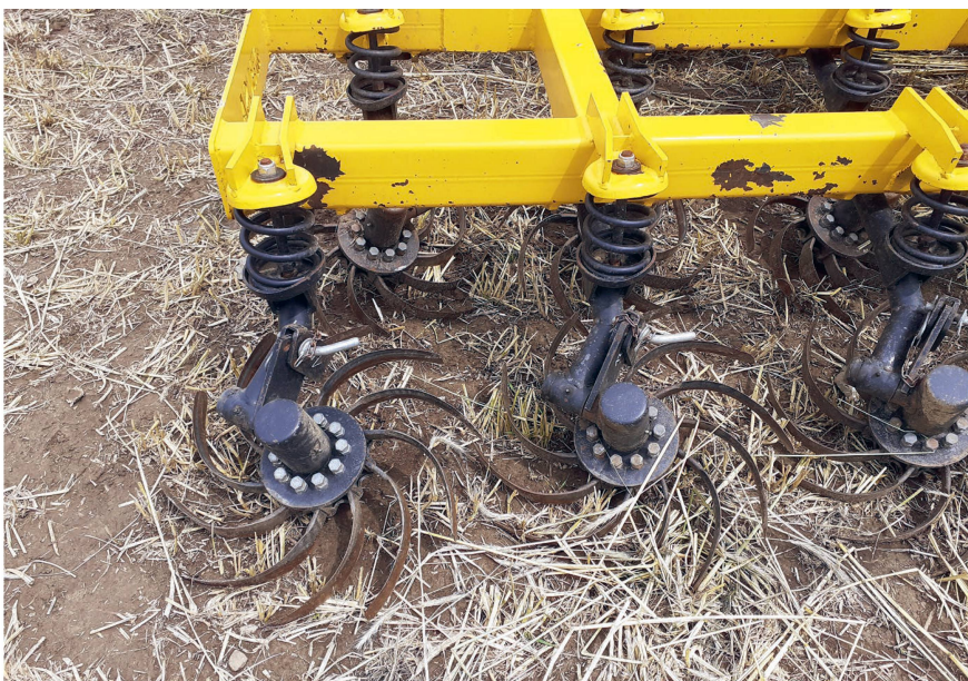
Der Eingriffswinkel des Rotors wird einzeln mithilfe eines Lochrasters und einem Bolzen eingestellt.
