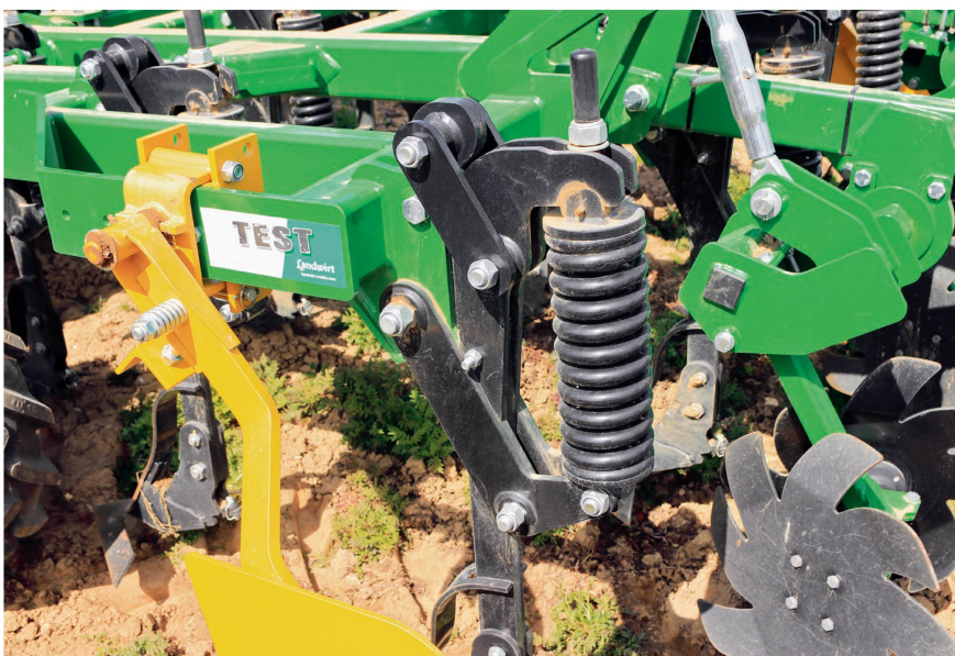
Die mechanische Überlastsicherung hat rund 800 kg Auslösekraft.
