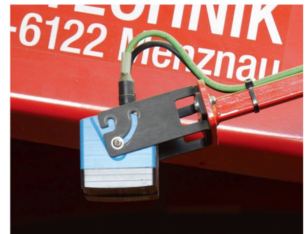
Für die Erkennung und «Einmessung» der Heuhaufen kommt eine 3D-Lichtradar-Kamera zum Einsatz.
