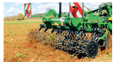
Die neue Striegelwalze eignet sich gut zum Herausköpfen von Unkräutern.
