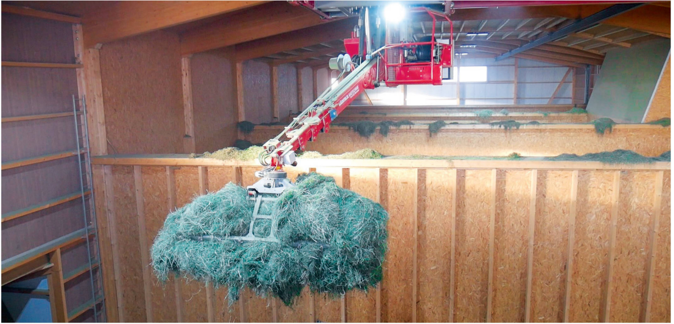
Der Heukran greift die Dürrfutter-Haufen autonom ab und befördert bis zu 40 m³ in zehn Minuten auf den Heustock. Bilder: Roman Engeler
