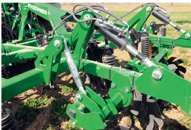
Die hydraulische Arbeitstiefenverstellung und die zentrale Verstellung der Sternräder erfolgt mittels Spindel.
