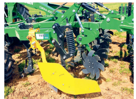
Für einen sauberen Anschluss ohne Dammbildung sorgen die Randbleche.
