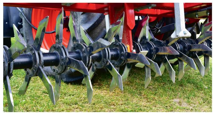
Mechanische Belüftung von Grünlandböden – besser ist es, Verdichtungen zu vermeiden! Bild: Ruedi Hunger
