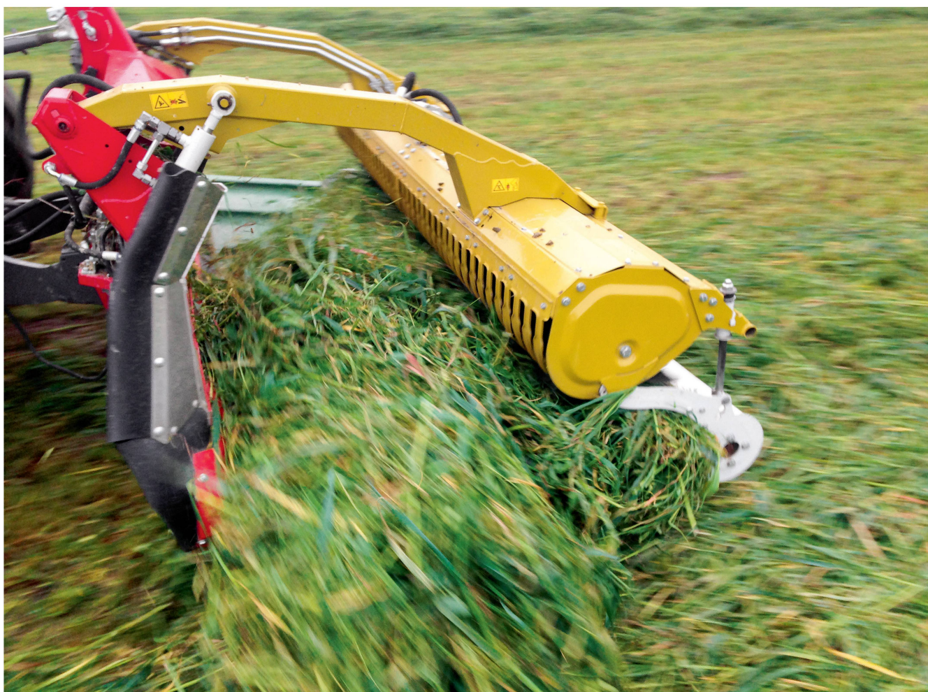
Pick-up-Schwader im Frontanbau, das Futter wird nicht überfahren, es entstehen weniger Bröckelverluste. Bild: Reiter
