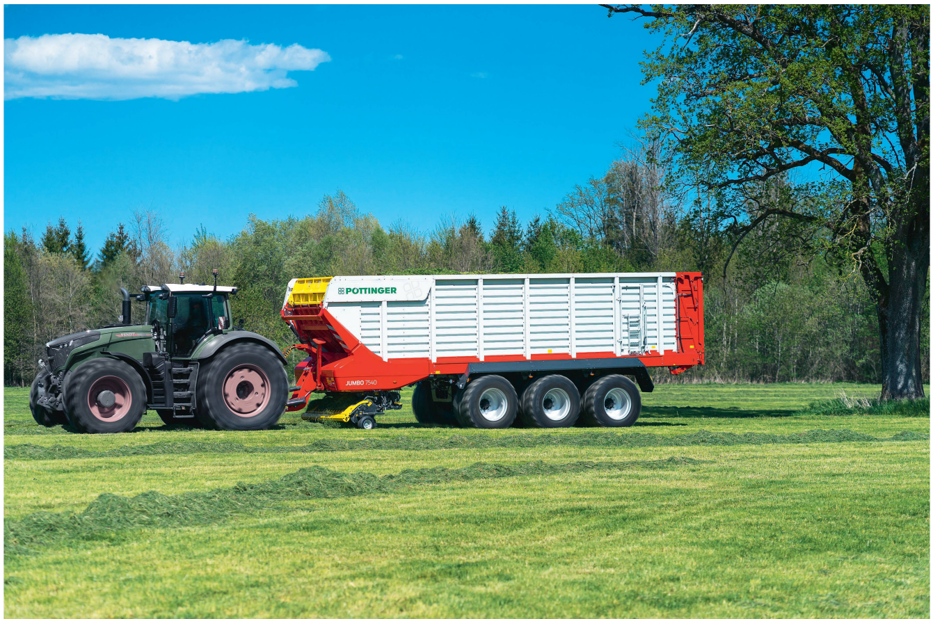
Kurzschnittladewagen sind bei geringer Feld-Hof-Entfernung und kleinen Schlägen kostengünstiger. Bild: Pöttinger
