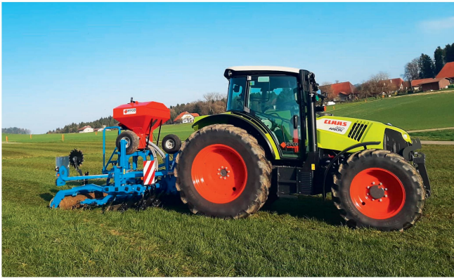
Oft bestehen Pflegegeräte heute aus einer Kombination von Einebnungswerkzeug, Striegel, Walze und Sägerät. Bild: Serco
