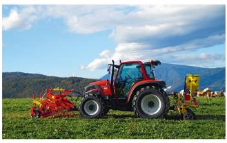
Pflegekombinationen in aufgelöster Bauart erlauben auch die Verwendung kleinerer Traktoren. Bild: Apv
