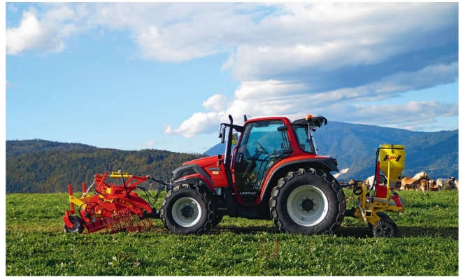
Pflegekombinationen in aufgelöster Bauart erlauben auch die Verwendung kleinerer Traktoren. Bild: Apv
