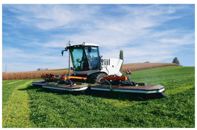
«Swiss made», 8,5 t Eigengewicht, 350 PS und eine Arbeitsbreite von 11 m, das sind die Eckpunkte des «Cutaro». Bild: ARB-Tec AG
