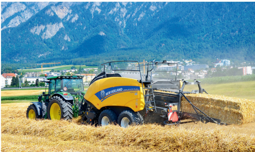
New Holland hat vor rund einem Jahr ein System vorgestellt, um automatisch Quaderballen mit einem einstellbaren Gewicht zu pressen.
