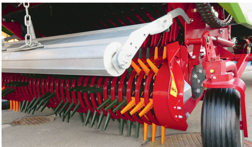
Pick-ups sind immer wieder für Überraschungen gut, hier das «Flex-Load Pick-up» mit spiralförmig eingebauten, flexiblen Kunststoffzinken. Bilder: Ruedi Hunger
