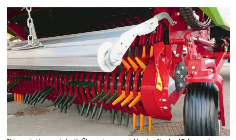
Pick-ups sind immer wieder für Überraschungen gut, hier das «Flex-Load Pick-up» mit spiralförmig eingebauten, flexiblen Kunststoffzinken. Bilder: Ruedi Hunger
