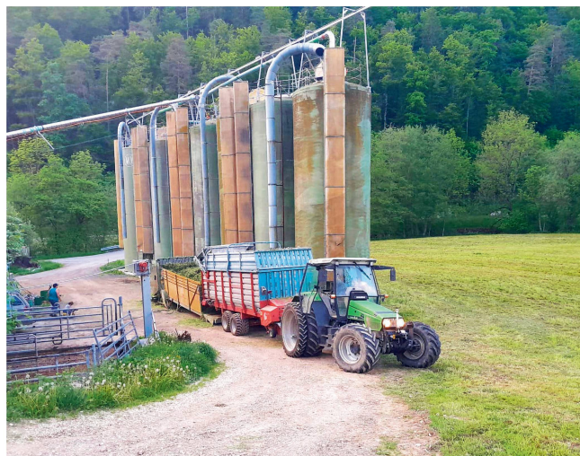
Der Deutz-Fahr «Agrostar 6.08» mit Mengele «543»-Erntewagen bei der Silagebergung mittels Stocker-Standhäcksler.
