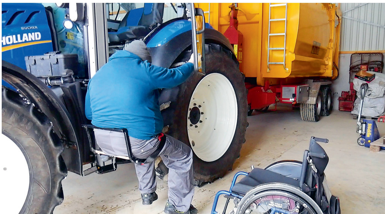
Am Spindellift ist eine klappbare Sitzplattform angebracht, mit der Maik Näf sich per Fernbedienung noch oben hieven kann. Bilder: Roman Engeler
