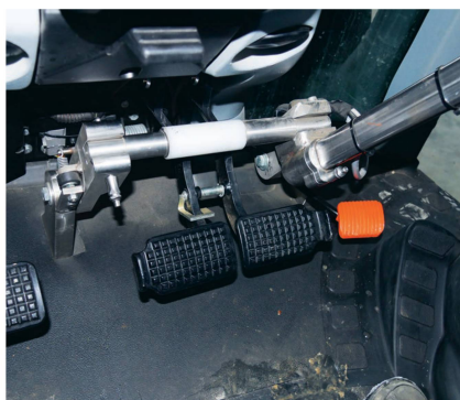
Die Fussbremse in der Kabine wird über eine spezielle Gestänge-Konstruktion per Hand bedient.
