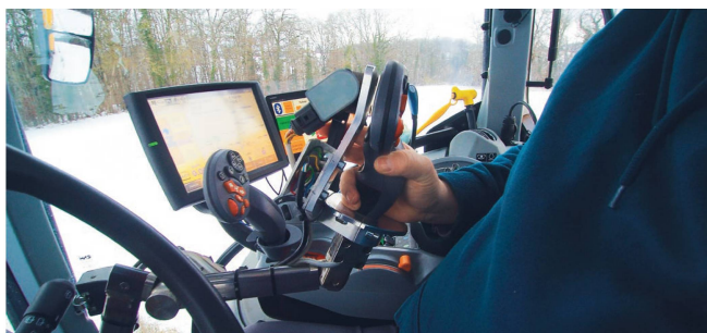
Am Gestänge befindet sich ein Joystick, quasi eine Kopie des in der Seitenkonsole serienmässig integrierten Multifunktionshebels.
