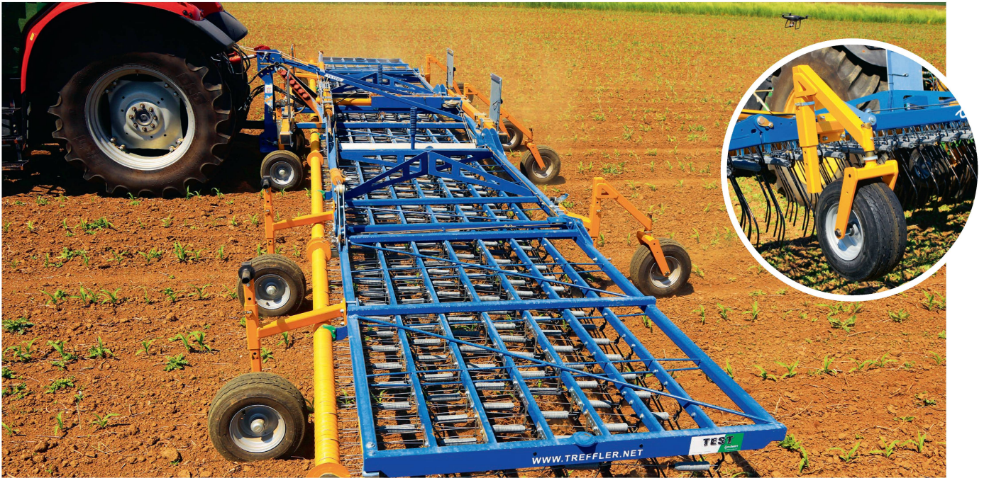
Der Rahmen des Treffler «TS 1220 M3» ist durchdacht und entsprechend leicht konstruiert. Die hinteren Räder sind mit einer mechanischen Pendelsicherung ausgestattet. Angeboten werden vier Zinkenvarianten: mit 105° oder 120° sowie mit oder ohne Hartmetall.
