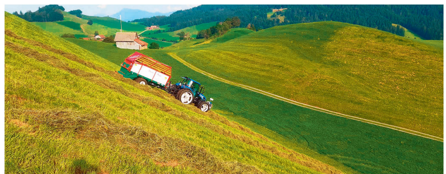
Auch beim Abwärtsfahren ist die Sicherheit gewährleistet (im Bild die Lenktriebchachs System «Urs Schmid»).
