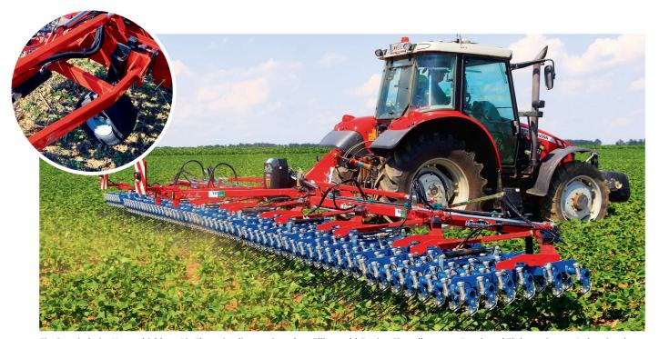
Einzigartig beim Hatzenbichler «Air-Flow» ist die voneinander völlig unabhängige Einstellung von Druck und Zinkenneigung. Jeder einzelne Zinken wird von einem kleinen Pneumatikzylinder gefedert. Die Tasträder lassen sich in der Spurweite kaum verstellen.
