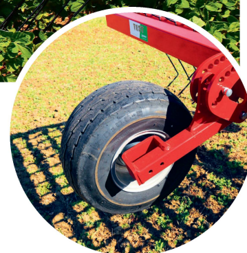
Horsch hat sein System aus Federpaketen und Zugseilen über dem Rahmen verbaut. Bei den Tasträdern hat der Striegel einige Besonderheiten zu bieten. Höhe und Spurweite der Räder sind gut verstellbar.
