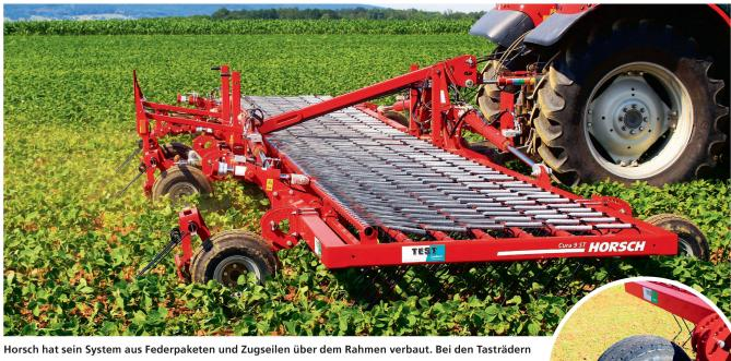
hat der Striegel einige Besonderheiten zu bieten. Höhe und Spurweite der Räder sind gut verstellbar.
