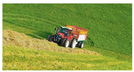
Dank Knickdeichsel ist das Einfahren in einen Hang und das Überfahren einer Geländekante problemlos möglich («X-Trailer» von Trachsel Technik).
