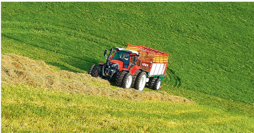
Dank Knickdeichsel ist das Einfahren in einen Hang und das Überfahren einer Geländekante problemlos möglich («X-Trailer» von Trachsel Technik).
