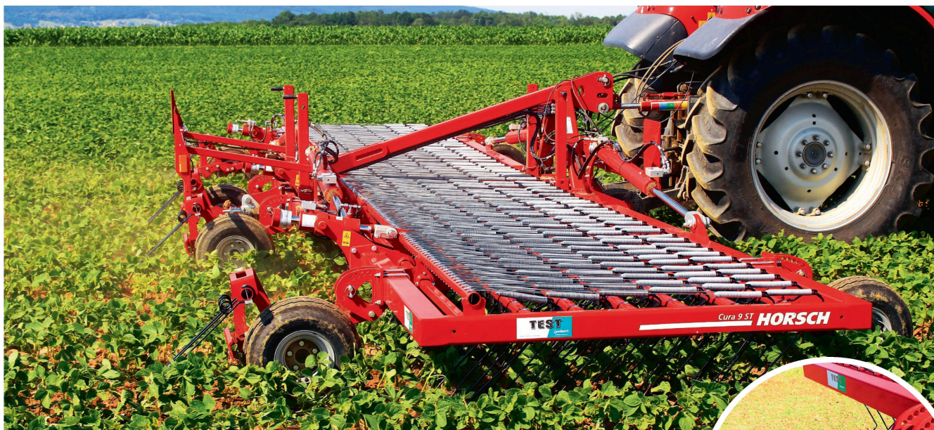
Horsch hat sein System aus Federpaketen und Zugseilen über dem Rahmen verbaut. Bei den Tasträdern hat der Striegel einige Besonderheiten zu bieten. Höhe und Spurweite der Räder sind gut verstellbar.
