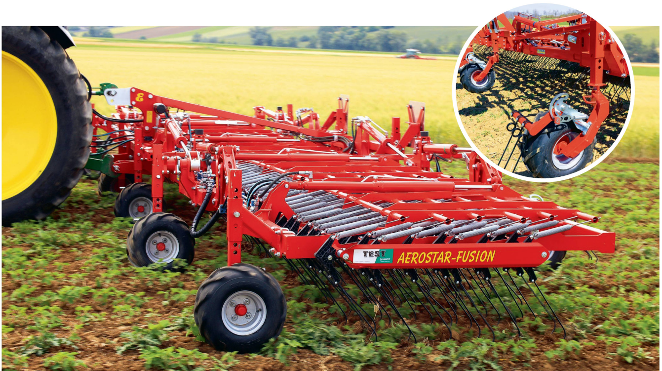
Die Vorserienmaschine des «Aerostar-Fusion 1200» hatte noch mit Übergewicht zu kämpfen. Das möchte Einböck in der Serienproduktion verbessern. Die Tasträder sind schwer, haben aber gute Griffe. Die Nachlaufstriegel sind serienmässig aufgebaut.
