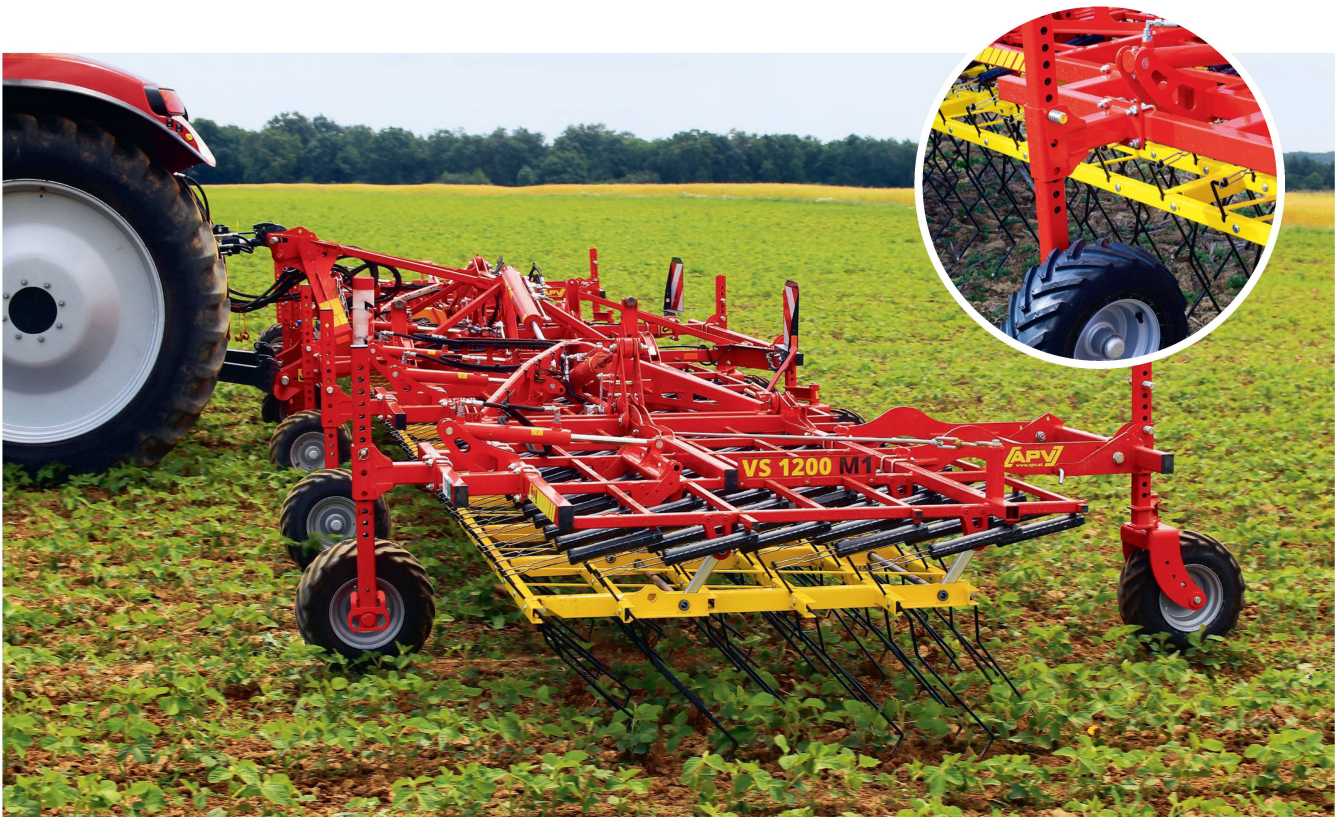
Der Rahmen des APV «Variostriegels» ist leicht, aber stabil. Die Tasträder sind gut in der Höhe und Spur verstellbar. Der gelbe Rahmen wird hydraulisch nach vorne oder hinten verschoben. Dadurch ändert sich die Neigung und der Zinkendruck.
