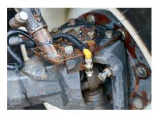
Der von Tobias Futter selbst eingebaute Lenkeinschlagssensor an der Vorderachse für die automatische Allradabschaltung.
