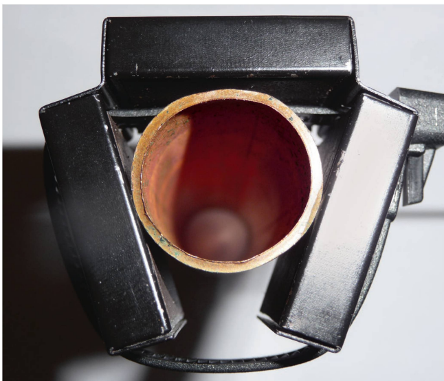
Die Permanentmagnete (hier in dieser Schnittdansicht sichtbar) sind auf beiden Seiten des Kanals positioniert, der den Motor mit Treibstoff versorgt. Bilder: Christophe Royer
