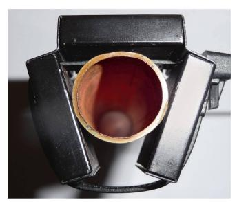
Die Permanentmagnete (hier in dieser Schnittansicht sichtbar) sind auf beiden Seiten des Kanals positioniert, der den Motor mit Treibstoff versorgt. Bilder: Christophe Royer
