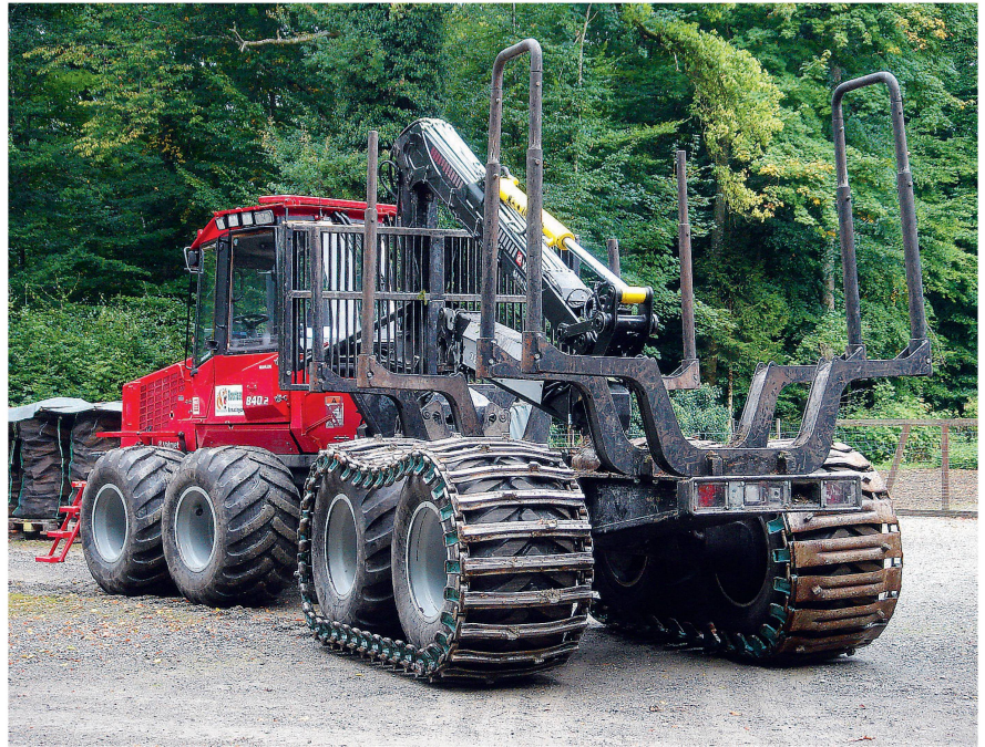
Dieser Forwarder wurde zu Demonstrationszwecken mit zwei verschiedenen Arten von Bogiebändern ausgerüstet: links Traktionsbänder zur Verbesserung der Steigfähigkeit und der Sicherheit am Hang, rechts tragende Bänder zur schonenderen Befahrung schlecht tragfähiger Böden.
