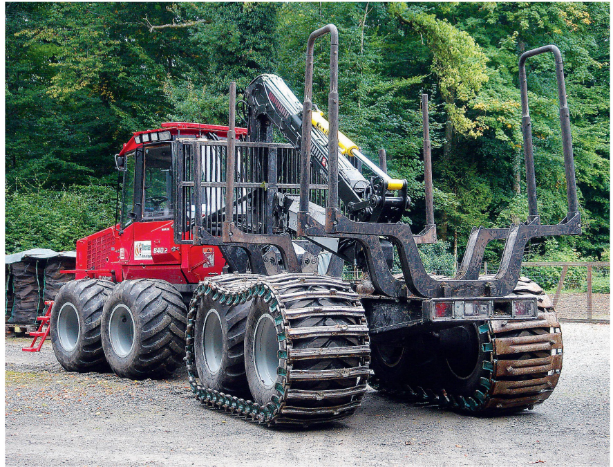
Dieser Forwarder wurde zu Demonstrationszwecken mit zwei verschiedenen Arten von Bogiebändern ausgerüstet: links Traktionsbänder zur Verbesserung der Steigfähigkeit und der Sicherheit am Hang, rechts tragende Bänder zur schonenderen Befahrung schlecht tragfähiger Böden.
