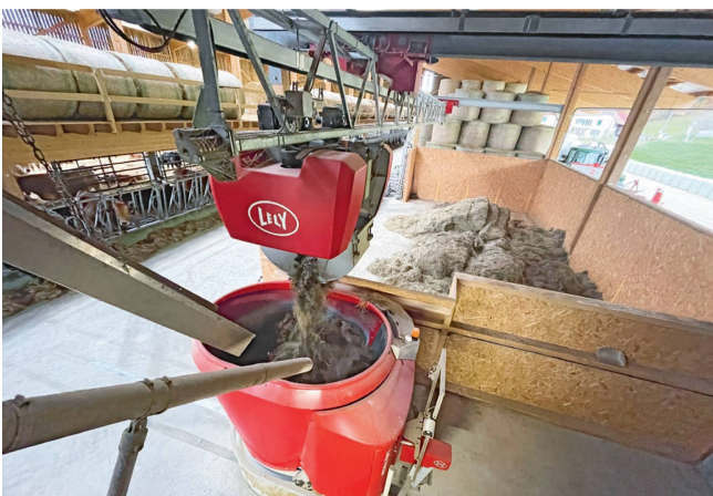
Die sechs Vollrationen werden vorbereitet, wenn der Roboter auf der Ladestation neben der Futterküche steht.
