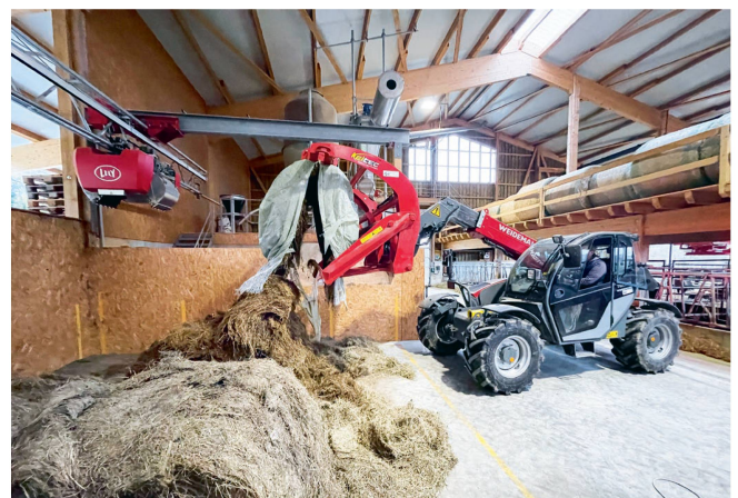
Die Rundballen werden in der Futterküche mit einer Schneidzange in zwei Hälften geteilt, um die Arbeit des Greifers zu erleichtern.
