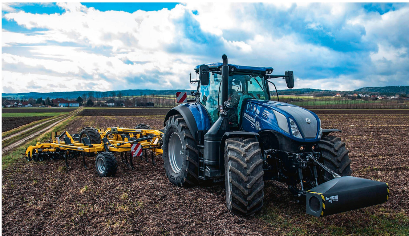
Der Isobus-fähige Bodensensor «Soilxplorer» wird zur Steuerung der Arbeitstiefe oder zur teilflächenspezifischen Aussaat in Echtzeit eingesetzt. Bild: CNH
