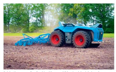
Bei der Konzeptstudie «Combined Powers» bilden Antriebseinheit und Anbaugerät eine autonome Einheit. Bild:  $\mbox{VTE}$
