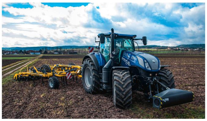
Der Isobus-fähige Bodensensor «Soilxplorer» wird zur Steuerung der Arbeitstiefe oder zur teilflächespezifischen Aussaat in Echtzeit eingesetzt. Bild: CNH
