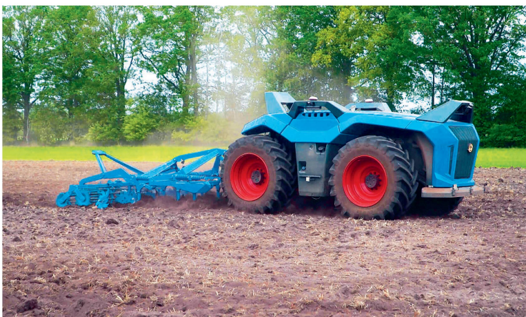
Bei der Konzeptstudie «Combined Powers» bilden Antriebseinheit und Anbaugerät eine autonome Einheit. Bild: VTE
