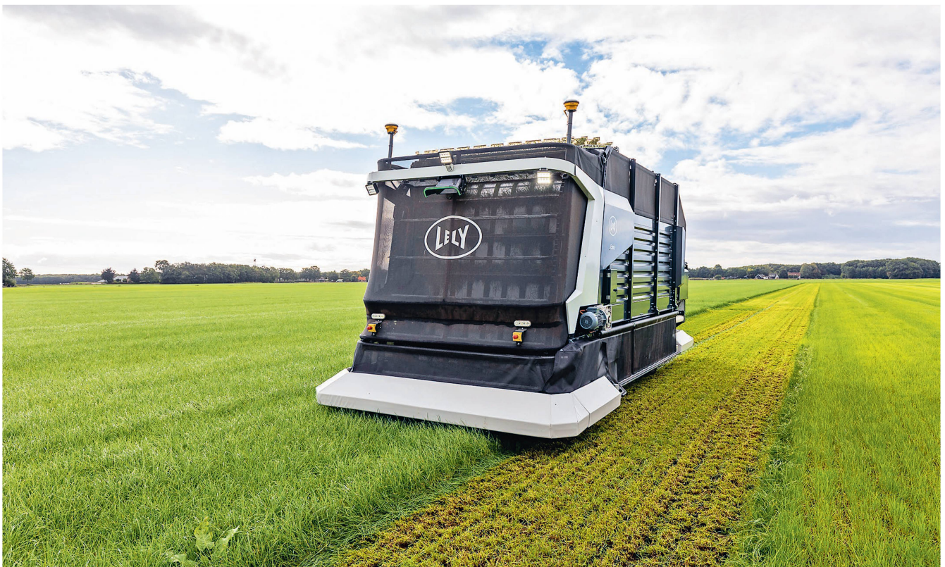
Der 5G-Mobilfunkstandard bringt zukünftige Landtechnik zum Laufen. Das Lely-«Exos»-Konzept für die autonome Ernte und Verfütterung von frischem Gras ist ein Beispiel von vielen, die auf 5G-Technologie angewiesen sind. Bild: Lely
