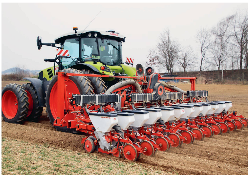
Die überschnittfreie Saat mit SectionControl wurde erst durch die Digitalisierung möglich.
