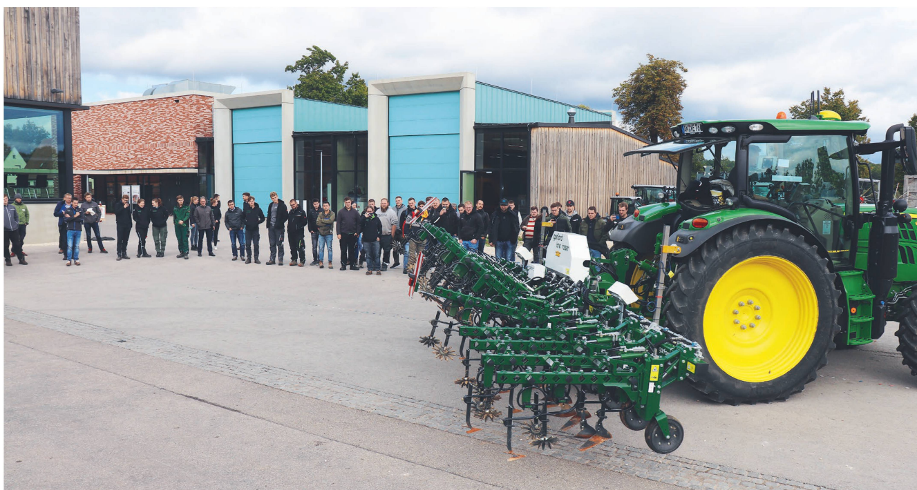
Vorführung der «Section-Control»-Funktion bei einer hydraulisch angesteuerten Hacke von Garford.
