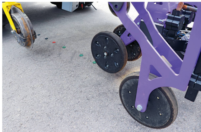
Feldklasse führt die Funktion der kameragesteuerten Hackmesser mit Hilfe von Pokerchips vor.
