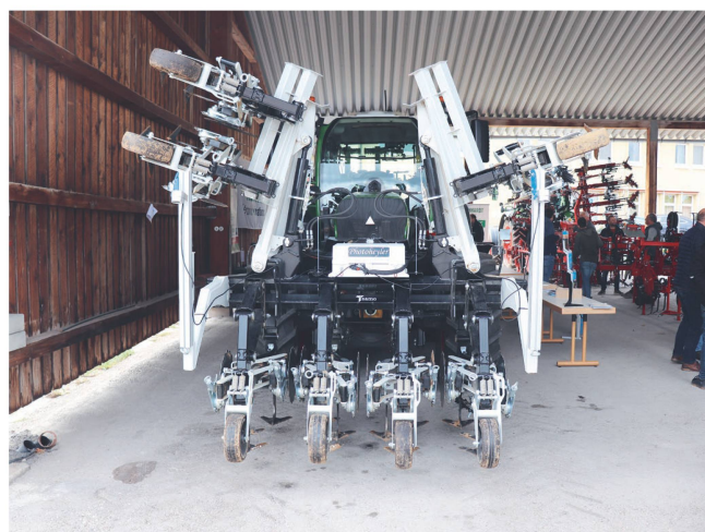
Beim «VarioChop» von Samo kann die Hackbreite der Segmente mit nur zwei Handgriffen verändert werden.
