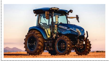
Weiter wurde mit dem New Holland «T7 Methane Power LNG» der weltweit erste Traktor gezeigt, der mit flüssigem (Bio-)Gas (LNG Liquefied Natural Gas) angetrieben wird. Im Vergleich zum schon am Markt erhältlichen «T6 Methane Power» mit komprimiertem Gas verfügt die neue LNG-Version über eine Vervierfachung der Kraftstoffkapazität, da flüssiges Gas eine höhere Energiedichte hat als das komprimierte CNG.
