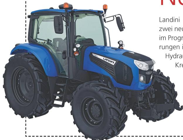
Landini hat mit der Serie «6H T-Tronic» zwei neue Traktoren in der 120 PS-Klasse im Programm. Eine der wichtigsten Neuerungen ist neben dem Stufe-5-Motor die Hydraulikanlage mit geschlossenem Kreislauf sowie die Federung der Kabine und der Achse. Beide Modelle haben einen «F36»-Motor mit 3,6 l Hubraum. Der «6-125H» leistet bis zu 119 PS, der «6-135H» bis zu 127 PS. Erhöht hat Landini das maxi-
