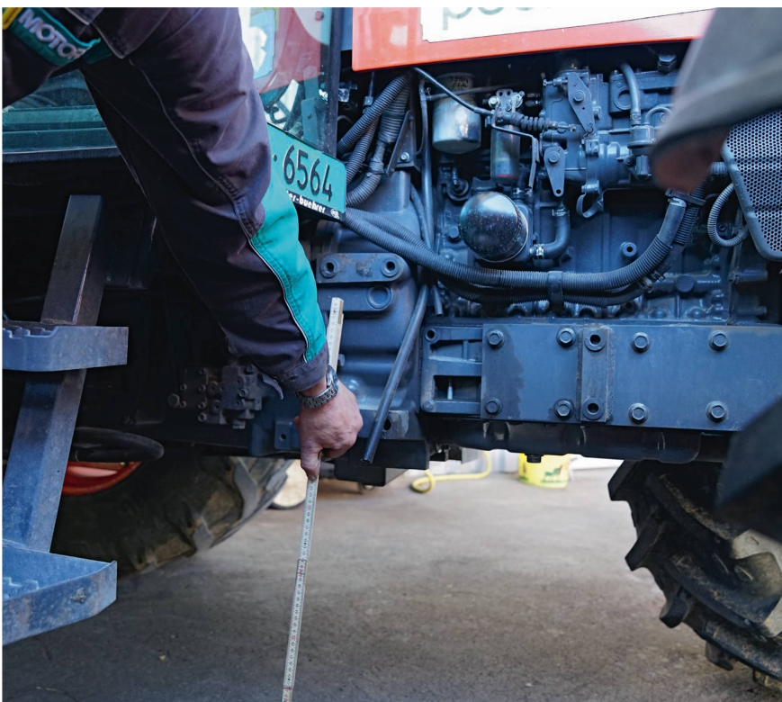
Enorme Bodenfreiheit von 46 cm beim Kubota «M135GX».
