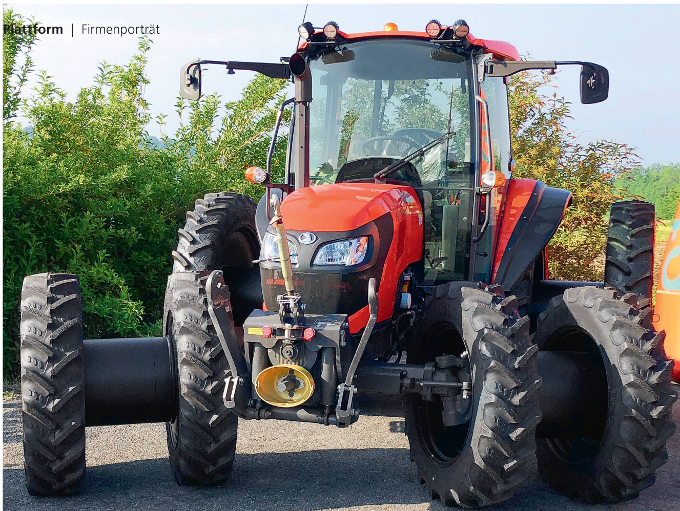
Dank Zahnverbindung ist eine Zwillingssradmontage für alle Radgrößen in jeder Stellung möglich, für Pfliegeräder gibt es Distanzringe in unterschiedlichen Ausführungen. Bilder: Agro Räder/Dominik Senn
