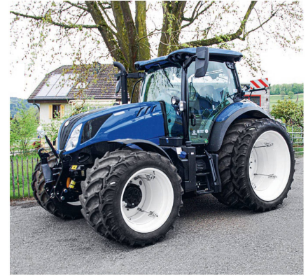
Das Doppelradsystem «Tractor-TWIN» ist für alle Traktoren(marken) geeignet.
