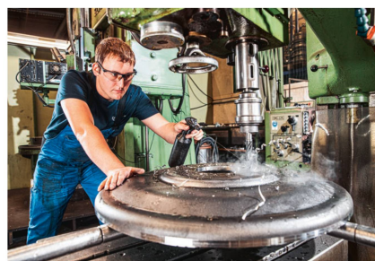
Gefragt ist höchste Präzision. Wie beim hochgenauen Drehen der Nabenlöcher und Teilkreise der Radscheibe auf der Karussell-Drehbank (Bild rechts).
