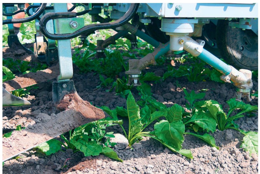
Der «Farming GT», mit dem nur gehackt wird, arbeitet mit rotierenden Fräsköpfen zwischen den Pflanzen und mit Schar-Werkzeugen zwischen den Reihen.
