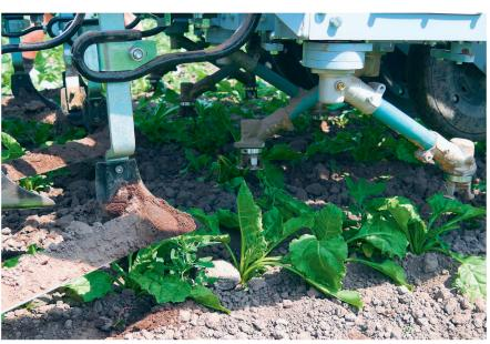
Der «Farming GT», mit dem nur gehackt wird, arbeitet mit rotierenden Fräsköpfen zwischen den Pflanzen und mit Schar-Werkzeugen zwischen den Reihen.
