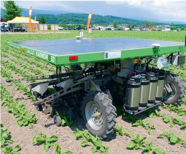
Wie viele Handarbeitstunden können mit Hackrobotern eingespart werden? Das soll ein Versuch mit dem «Farming GT» (links) und dem «FarmDroid FD 20» auf einem 10 Hektar grossen Rübenfeld in Gampelen BE aufzeigen. Bilder: H. Röthlisberger
