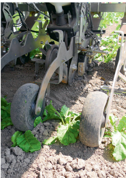
Mit dem «FarmDroid» kann sowohl gesät als auch gehackt werden.
