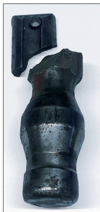
Das «Bolzenfieber» wird durch falsches Kombinieren von Kupplung und Zugöse verursacht.
