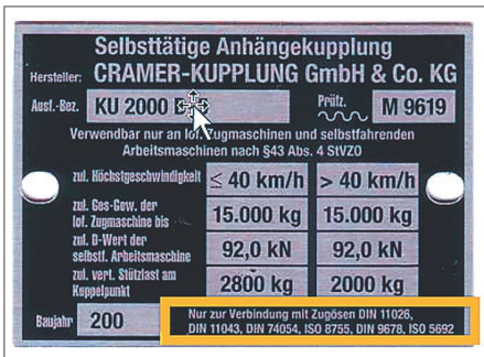
Typenschilder mit Angabe, welche DIN-Zugösen gekuppelt werden dürfen.
