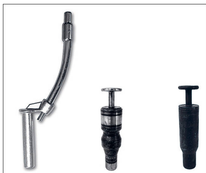
Verschiedene Bauformen von Kuppelbolzen.
