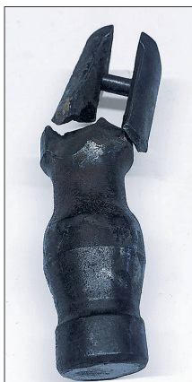
Das «Bolzenfieber» wird durch falsches Kombinieren von Kupplung und Zugöse verursacht.
