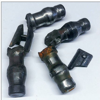
Das «Bolzenfieber» wird durch falsches Kombinieren von Kupplung und Zugöse verursacht.
