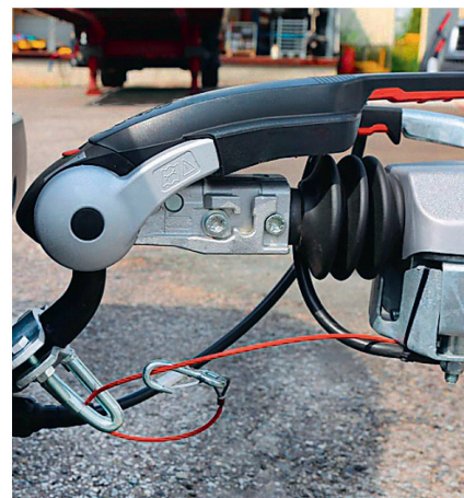
Die Abrissleine muss mit dem Karabinerhaken an einer Öse am Fahrzeug oder der Anhängerkupplung eingehängt werden. Bild: TCS
