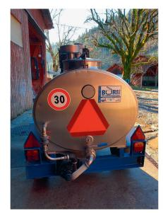
Bei Geschwindigkeiten bis 30 km/h muss ein Höchstgeschwindigkeitszeichen und eine Heckmarkierungstafel angebracht werden.
