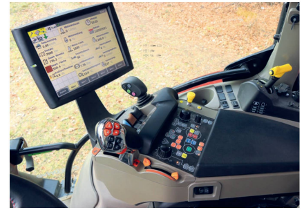
Armlehnenbedienung mit Multicontroller, Joystick und Touchterminal.
