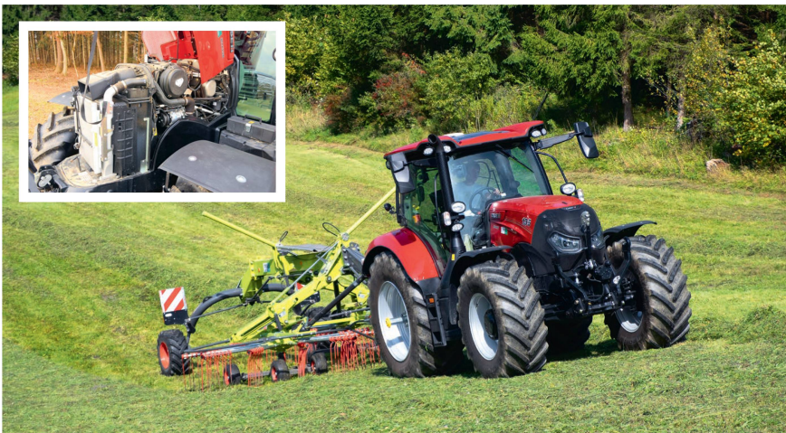
Die Kabine des «Maxxum 135 CVX Drive» ist nicht die modernste, aber sie war mit 65,9 dB(A) die leiseste im Test. Der Traktor hatte den stärksten Motor mit niedrigem Dieselverbrauch in der Testreihe.
