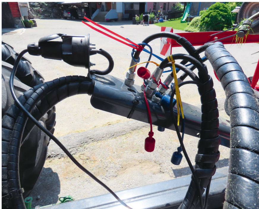
Eine vorbildliche Schlauchgarderobe, nur noch die Schlauchkennzeichnung und Halter für den Beleuchtungsstecker fehlen.
