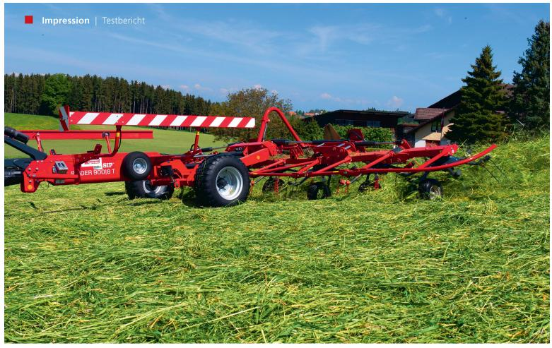
Der robuste Zetter «Spider 900/8T» von SIP passt sich mit den 145 cm Kreiseldurchmessern dem Boden gut an. Bilder: M. Abderhalden und R. Engeler
