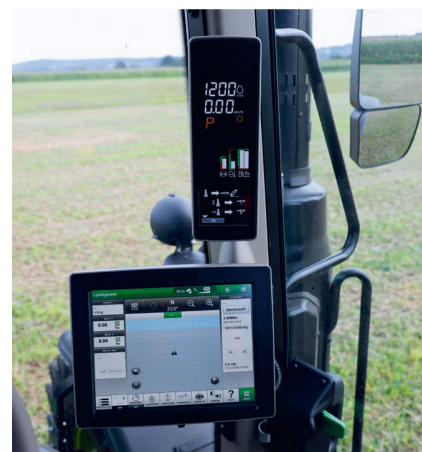
A-Säulen-Display mit optionalem Touchscreen «4240» für erweiterte Lenkfunktionen und Gerätesteuerung.
