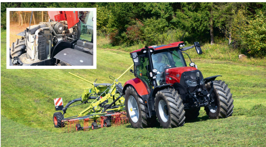
Die Kabine des «Maxxum 135 CVX Drive» ist nicht die modernste, aber sie war mit 65,9 dB(A) die leiseste im Test. Der Traktor hatte den stärksten Motor mit niedrigem Dieserverbrauch in der Testreihe.
