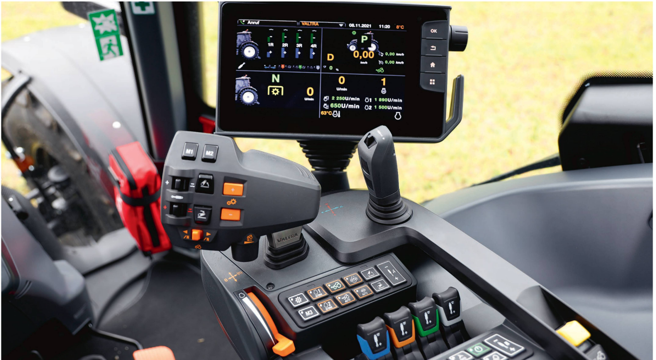
Das Bedienkonzept von Valtra wurde von allen Testfahrern gelobt. So gibt es eine Rückfahreinrichtung ab Werk.
