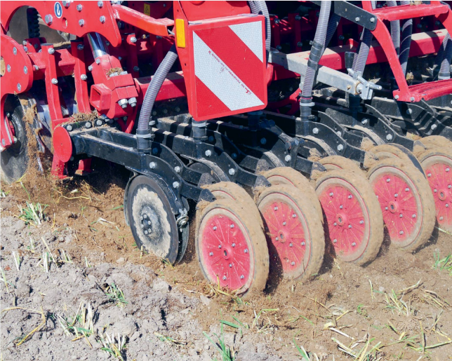
Die gummigelagerte «TurboDisc»-Doppelscheiben-Säschar zeichnet sich durch eine hohe Laufruhe aus.
