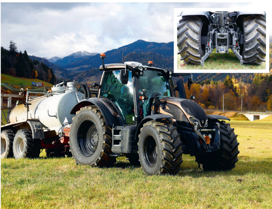
Der Valtra «N135 Direct» hatte die mit Abstand stärkste Hydraulik und das kräftigste Heck-Hubwerk im Test. Der stufenlose Traktor hat einen stärkeren Motor als das Modell mit Powershift-Getriebe.
