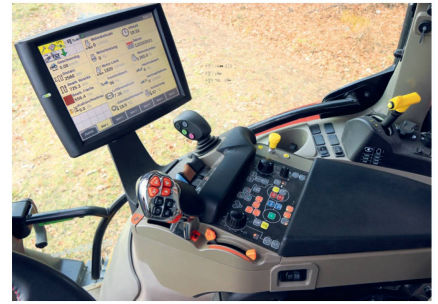
Armlehnenbedienung mit Multicontroller, Joystick und Touchterminal.
