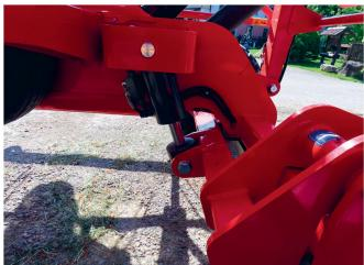
Die optionale, hydraulische Höhenverstellung benötigt einen doppelt wirkebdeb Hydraulikanschluss.
