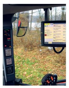
Das Isobus-Terminal ist beim Stevr nicht an der Armlehne, sondern am Haltebügel der rechten Kabinentür montiert.
