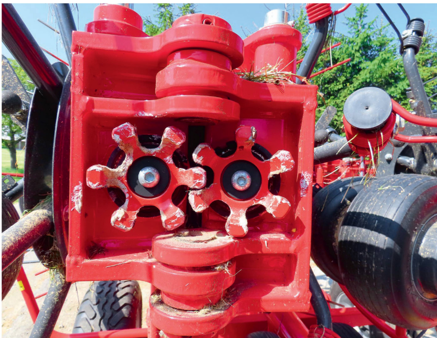
Die wartungsfreien Klauenkupplungen sorgen für ruhigen Lauf.
