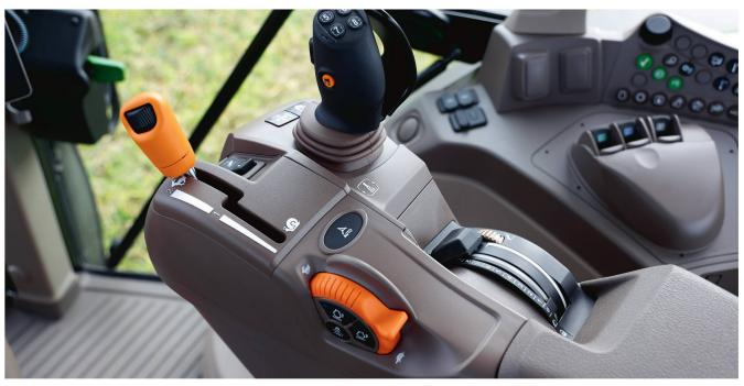
Kompakte Armlehne mit Getriebesteuerhebel, elektronischem Joystick, Hubwerksregelung und Handgasfunktionen.
