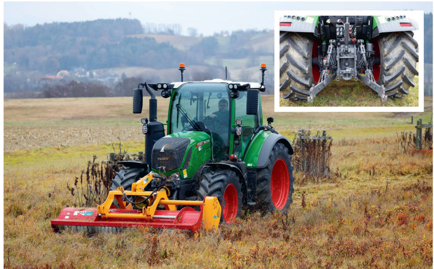
Der Fendt «314 Vario» hatte mit 58 kg/kW das niedrigste Leistungsgewicht bezogen auf die Zapfwellenleistung. Das Hubwerk zählte nicht zu den stärksten, hatte aber im Heck den grössten Hubbereich.
