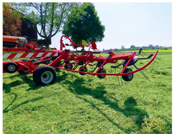
Beim Vorgewende-Aushub ziehen die äussersten die inneren Kreisel schön hoch.
