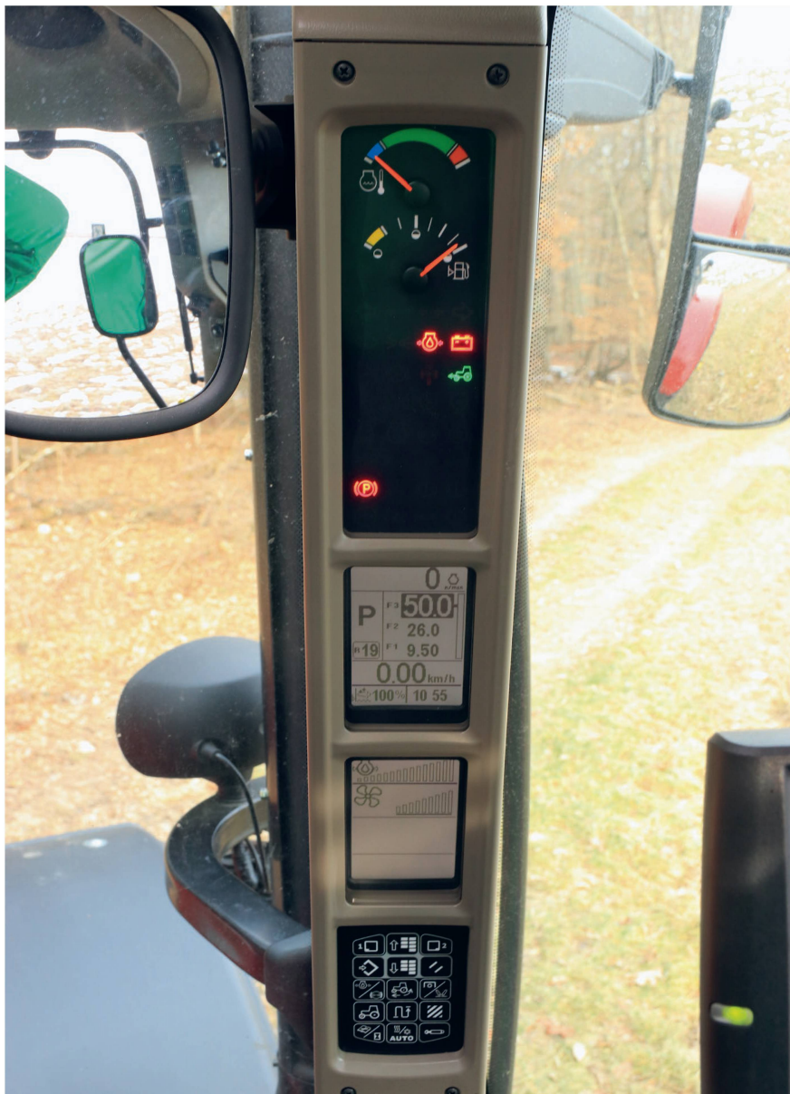
A-Säulen-Display mit allen relevanten Traktorfunktionen und einem Leistungsmonitor.
