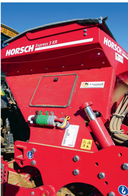
Die Saattiefen-Einstellung erfolgt hydraulisch und kann, wenn nötig, mit Clips an den Zylindern fixiert werden.
