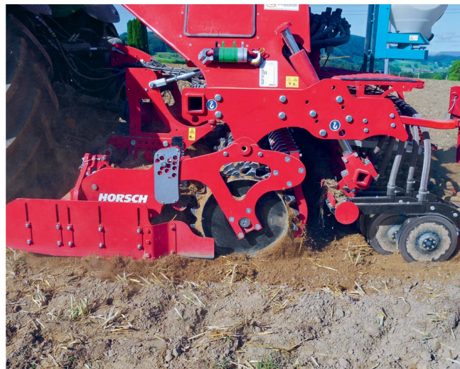
Schwer und massiv: Der 64-cm-Zahnpacker sorgt für eine gute Ausebnung und Rückverfestigung des Saatbettes.
