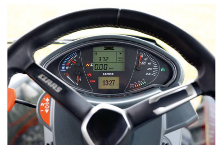
Das klassische Armaturenbrett schwenkt mit der Lenkrad-Neigungsverstellung mit.
