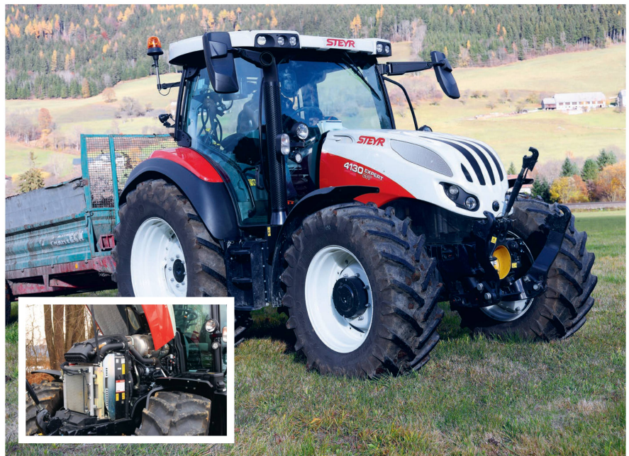
Die Kabine des Steyr «4130 Expert CVT» liefert mit serienmässigem FOPS-Schutz ideale Voraussetzungen für den Frontladereinsatz. Der FPT-Motor wies den höchsten Drehmomentanstieg und den grössten Konstant-Leistungsbereich auf.
