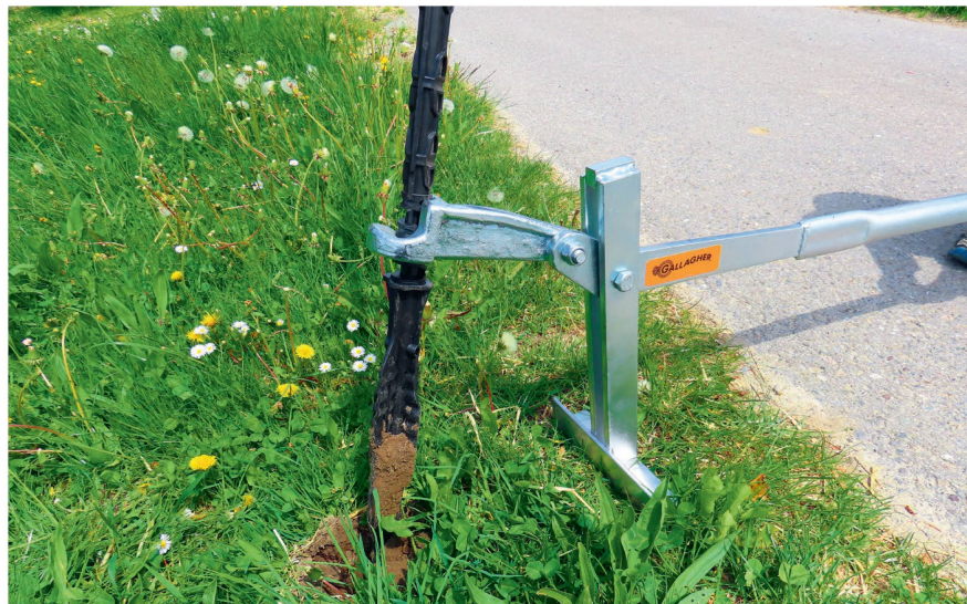
Um die Zaunpfähle auch wieder herausziehen zu können, braucht es dieses spezielle (oder ein ähnliches) Hebelwerkzeug.
