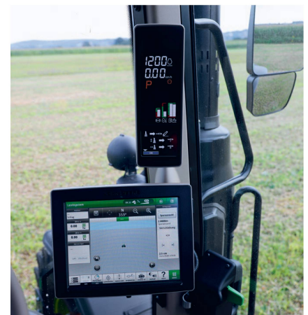
A-Säulen-Display mit optionalem Touchscreen «4240» für erweiterte Lenkfunktionen und Gerätesteuerung.
