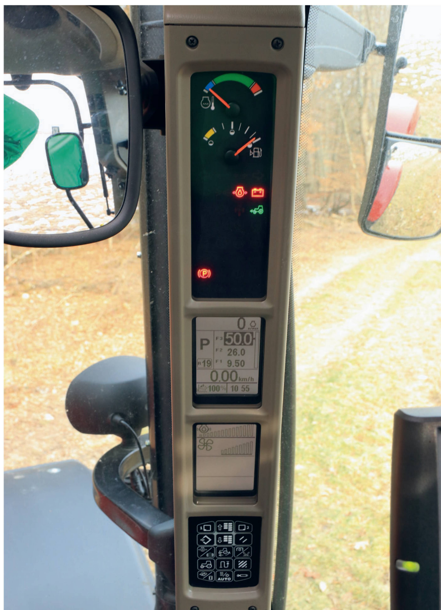
A-Säulen-Display mit allen relevanten Traktorfunktionen und einem Leistungsmonitor.
