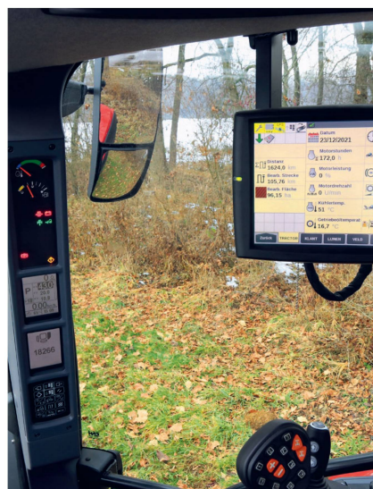
Das Isobus-Terminal ist beim Steyr nicht an der Armlehne, sondern am Haltebügel der rechten Kabinentür montiert.
