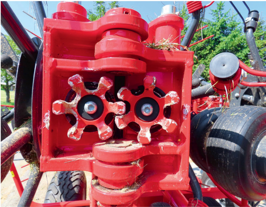
Die wartungsfreien Klauenkupplungen sorgen für ruhigen Lauf.
