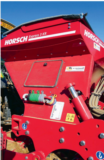
Die Saattiefen-Einstellung erfolgt hydraulisch und kann, wenn nötig, mit Clips an den Zylindern fixiert werden.
