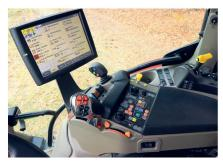
Armlehnenbedienung mit Multicontroller, Joystick und Touchterminal.
