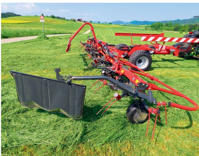
Das optionale Grenzstreutuch muss von Hand geklappt werden, eine hydraulische Klappung gibt es als zusätzliche Option.
