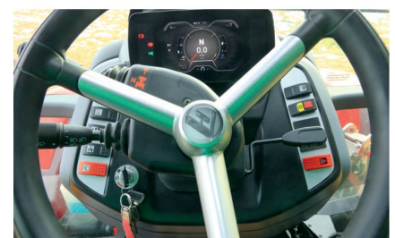
Das digitale Touchscreen-Terminal ist gleichzeitig Armaturenbrett und Bordcomputer.
