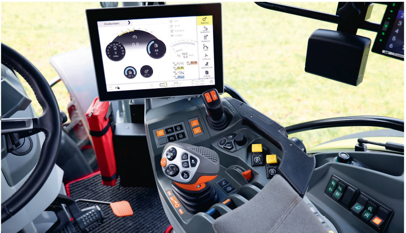
«Cebis»-Bedienung: Der Multifunktionshebel bietet viele Möglichkeiten und liegt gut in der Hand.
