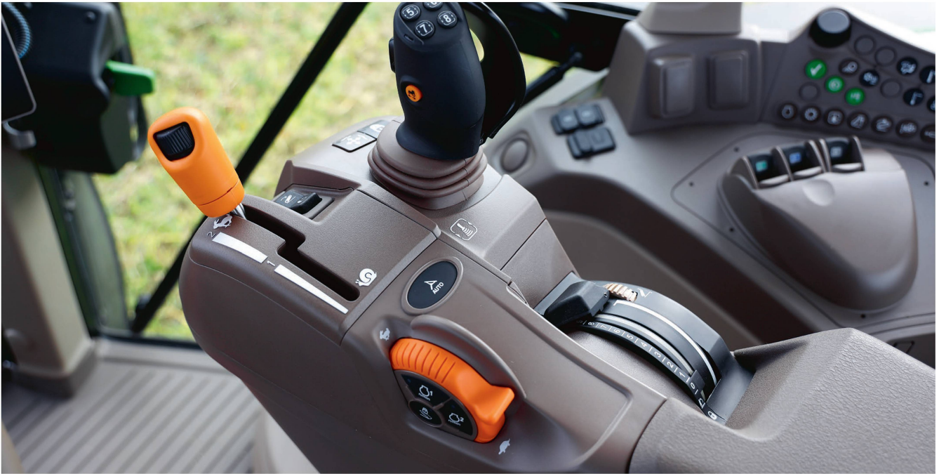
Kompakte Armlehne mit Getriebesteuerhebel, elektronischem Joystick, Hubwerksregelung und Handgasfunktionen.
