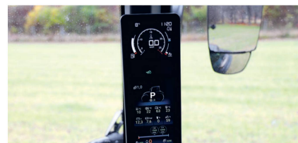
Valtra verbaut statt eines Armaturenbretts ein A-Säulen-Display. Dieses ist brillant, farbig und gut lesbar.
