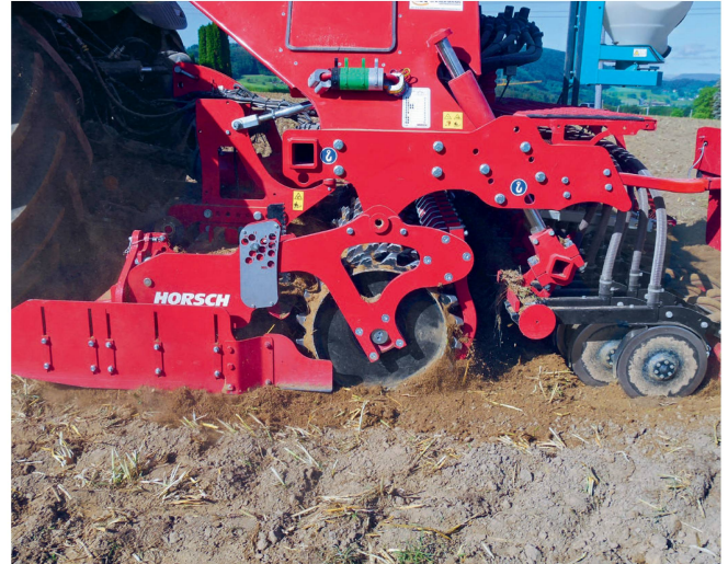
Schwer und massiv: Der 64-cm-Zahnpacker sorgt für eine gute Ausebnung und Rückverfestigung des Saatbettes.
