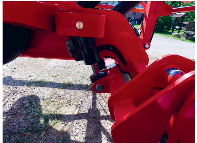
Die optionale, hydraulische Höhenverstellung benötigt einen doppelt wirkendeb Hydraulikanschluss.
