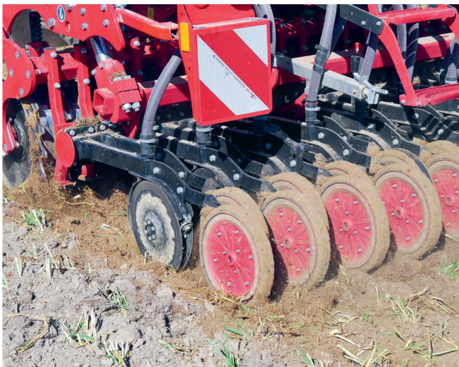
Die gummigelagerte «TurboDisc»-Doppelscheiben-Sächar zeichnet sich durch eine hohe Laufruhe aus.
