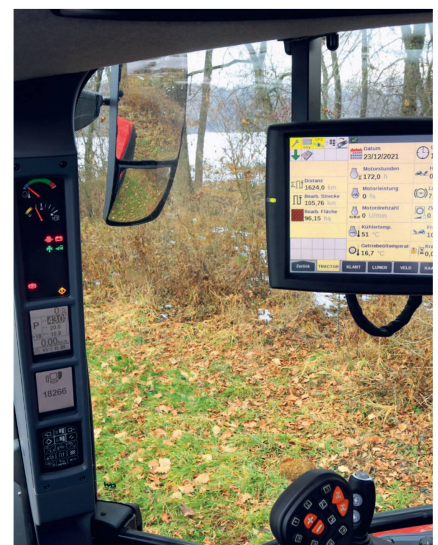
Das Isobus-Terminal ist beim Steyr nicht an der Armlehne, sondern am Haltebügel der rechten Kabinentür montiert.
