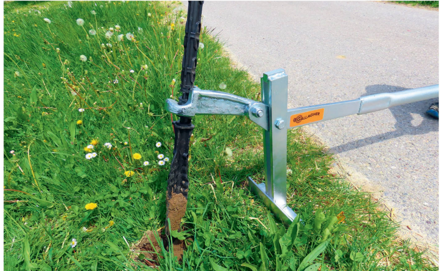
Um die Zaunpfähle auch wieder herausziehen zu können, braucht es dieses spezielle (oder ein ähnliches) Hebelwerkzeug.
