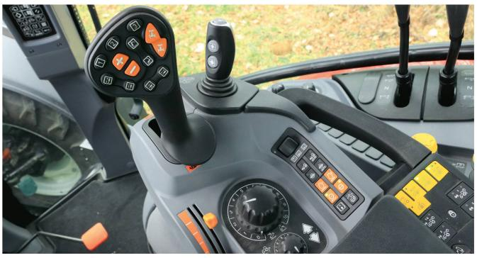
Die Bedienarmlehne mit Multicontrolhebel, Joystick und zahlreichen Bedienknöpfen macht einen modernen Eindruck.
