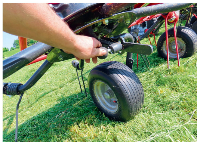
Der Streuwinkel lässt sich in drei Stufen über einen Schnellverschluss umstellen.
