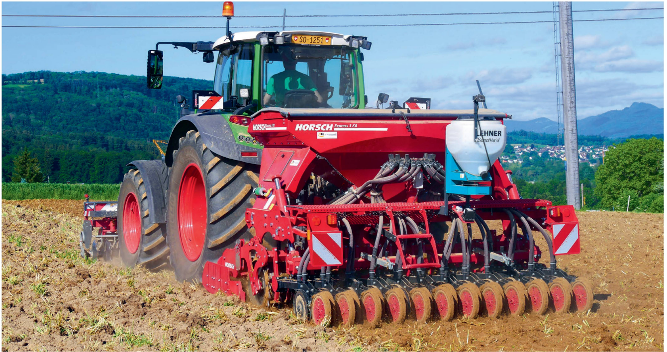
Die Horsch «Express 3 KR» mit Kreiselegge «Kredo» bei der Neuansaat von Kunstwiese. Bilder: H. Röthlisberger
