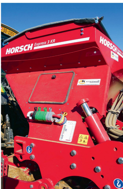
Die Saattiepen-Einstellung erfolgt hydraulisch und kann, wenn nötig, mit Clips an den Zylindern fixiert werden.
