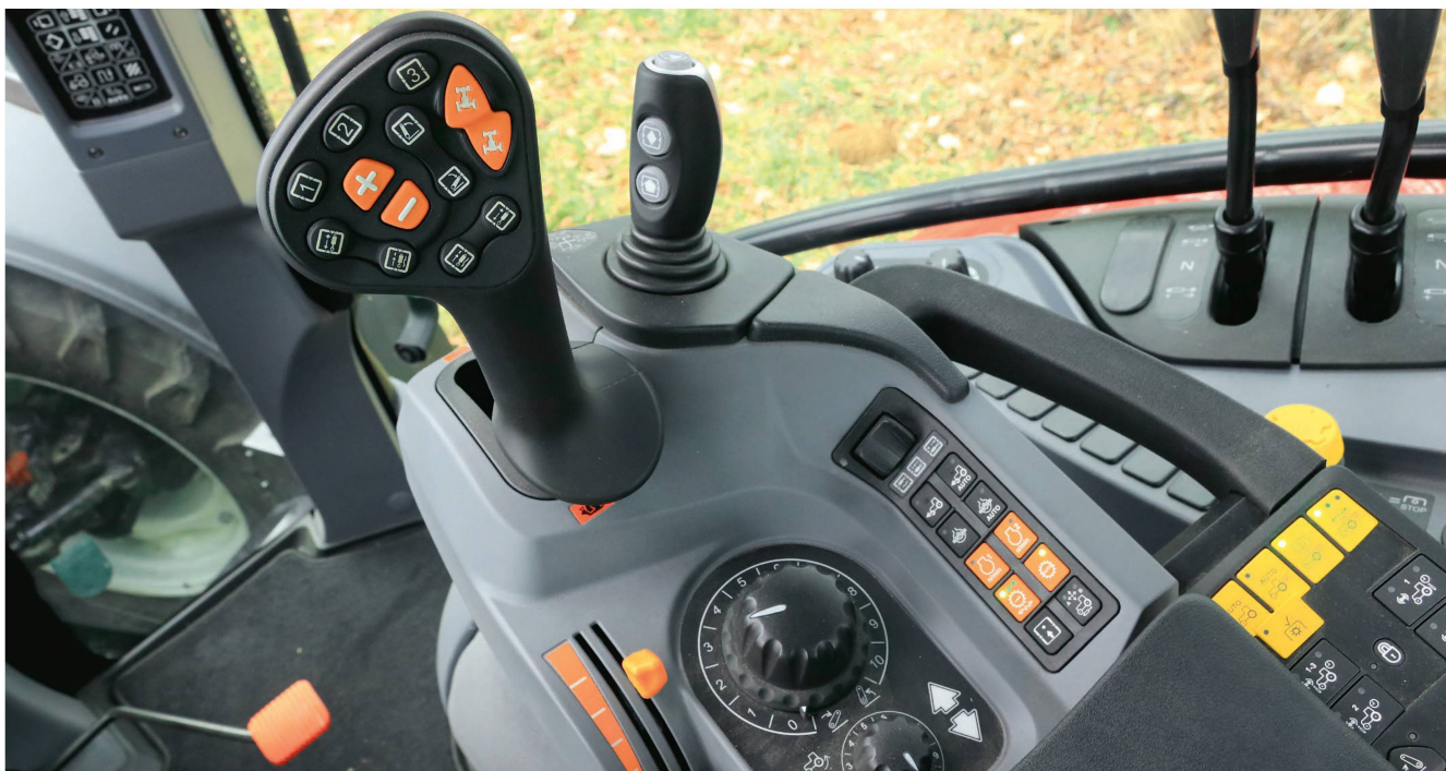
Die Bedienarmlehne mit Multicontrolhebel, Joystick und zahlreichen Bedienknöpfen macht einen modernen Eindruck.
