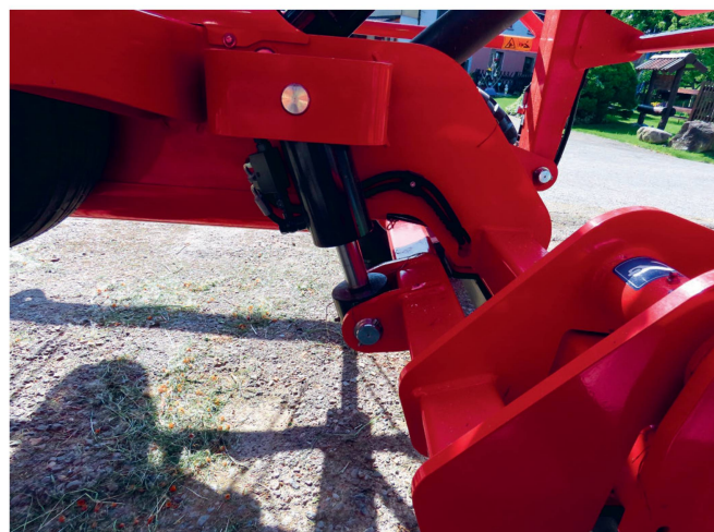
Die optionale, hydraulische Höhenverstellung benötigt einen doppelt wirkende Hydraulikanschluss.
