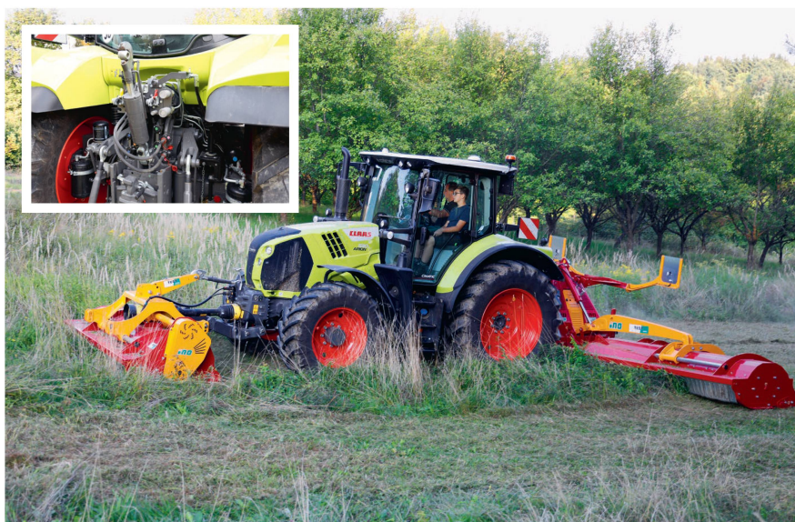
Claas hat beim «Arion 530 Cmatic» das Übersetzungsverhältnis zwischen der Motor- und der Zapfwellendrehzahl ideal gelöst. In der Ebene konnte man mit diesem Traktor am meisten Öl für externe Verbraucher entnehmen.
