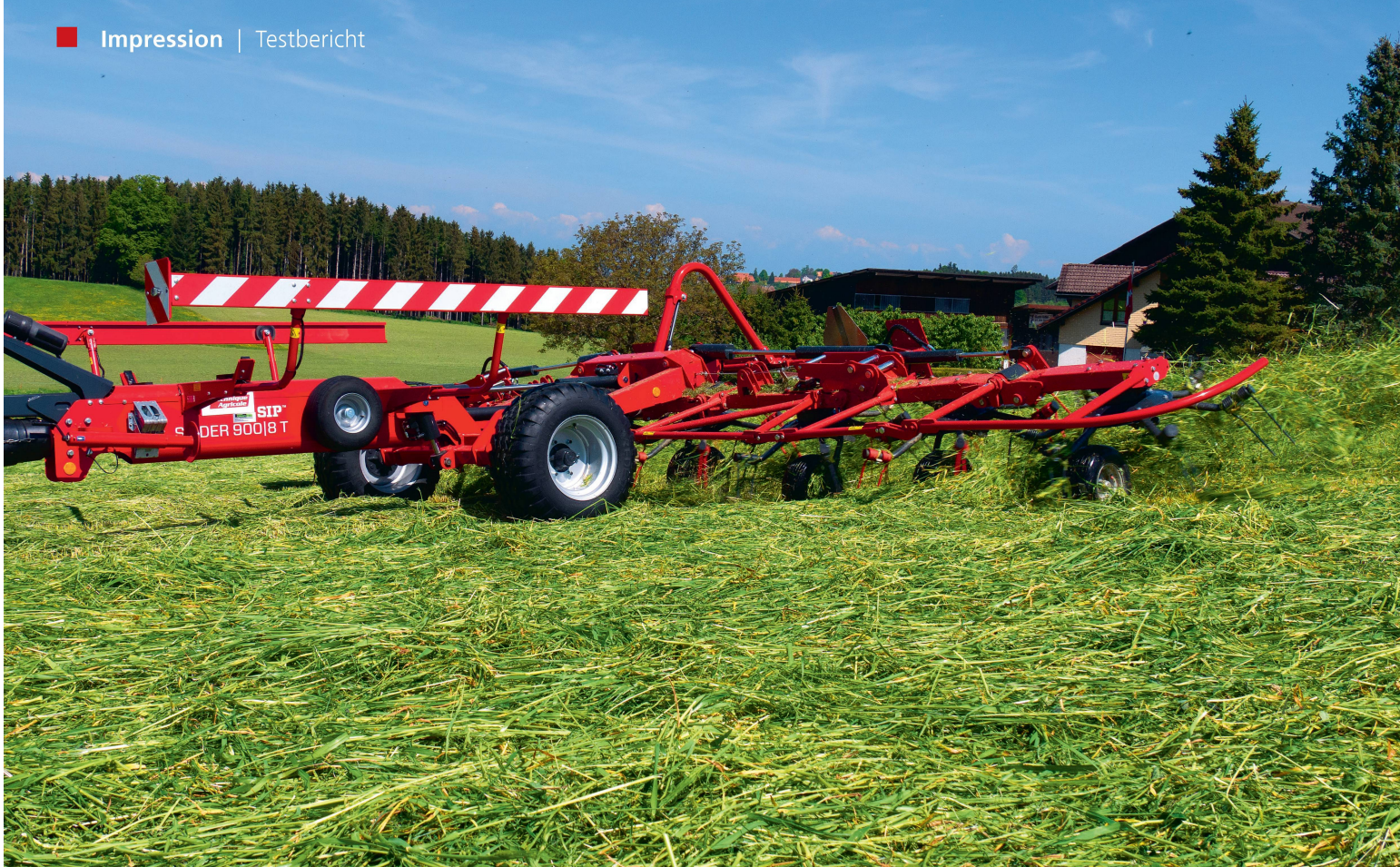
Der robuste Zetter «Spider 900/8T» von SIP passt sich mit den 145 cm Kreiseldurchmessern dem Boden gut an. Bilder: M. Abderhalden und R. Engeler
