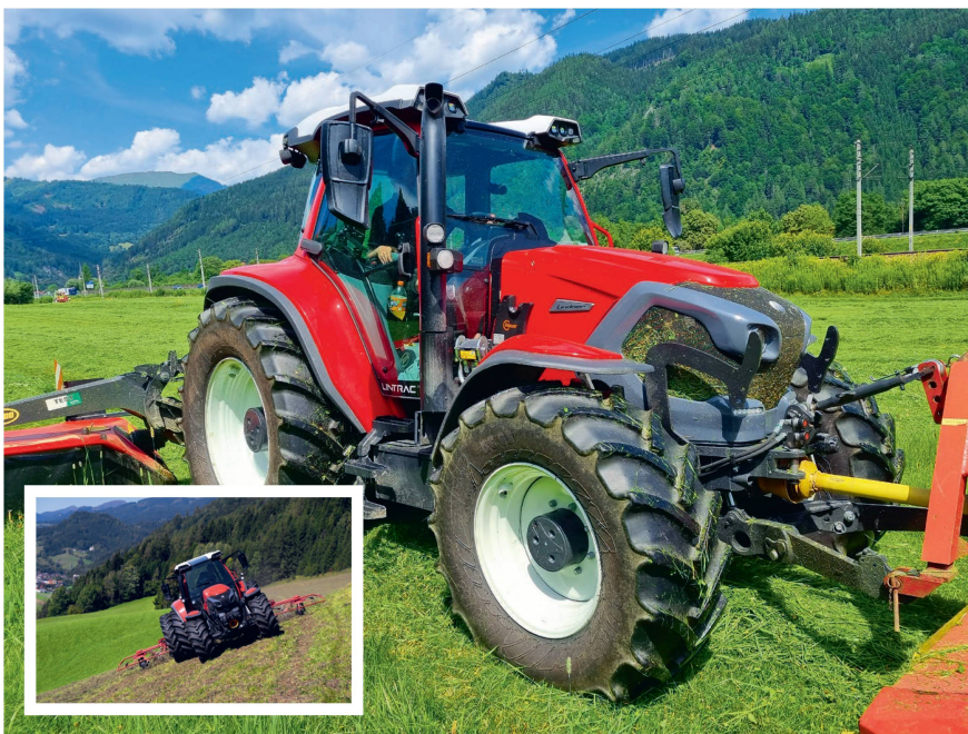
Dank Allradlenkung war der «Lintrac 130» mit Abstand der wendigste Testkandidat. Der Traktor brachte 5399 kg auf die Waage und war somit das Leichtgewicht in der Testreihe.
