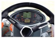
Das klassische Armaturenbrett schwenkt mit der Lenkrad-Neigungsverstellung mit.
