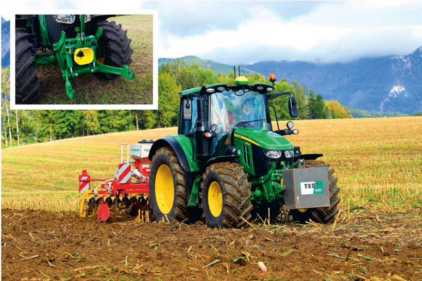
Der John Deere «6120M» erwies sich als Packesel: Er kann über 4 t zuladen und hatte zudem das stärkste Fronthubwerk. Auch die Heck-Hubkräfte sind ansehnlich.
