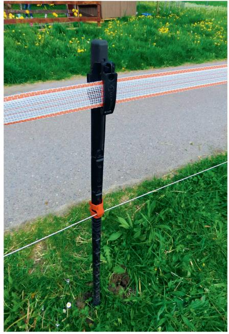
Mit dem selbstisolierenden «Line Post»-System lassen sich ohne maschinelle Hilfe schnell semipermanente Zäune erstellen. Bilder: M. Abderhalden
