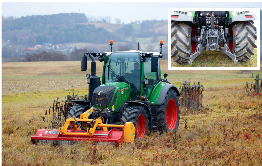
Der Fendt «314 Vario» hatte mit 58 kg/kW das niedrigste Leistungsgewicht bezogen auf die Zapfwellenleistung. Das Hubwerk zählte nicht zu den stärksten, hatte aber im Heck den grössten Hubbereich.
