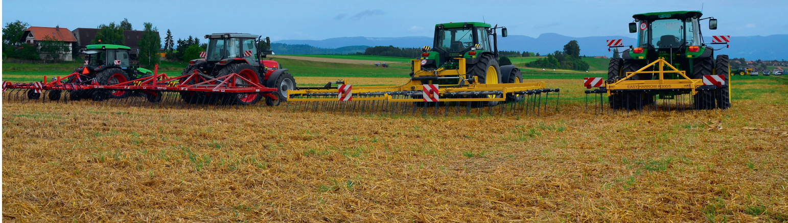
Strohstriegel verteilen nicht nur Stroh, sie bekämpfen auch Schnecken und Unkräuter. Bilder: R. Hunger
