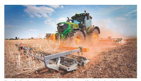
Eine aufgelöste Bauart mit Messerwalze an der Front und Strohstriegel am Heck. Bild: Wallner Maschinenbau
