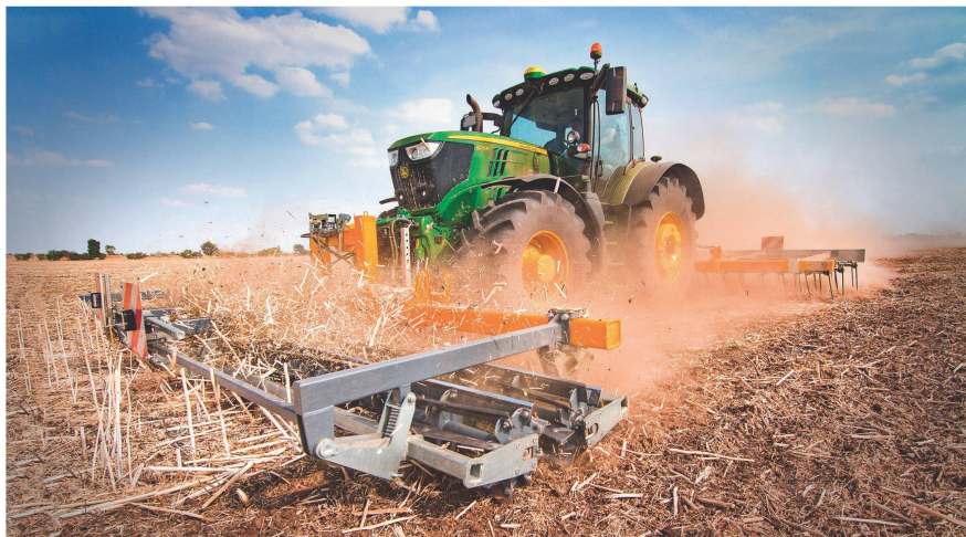
Eine aufgelöste Bauart mit Messerwalze an der Front und Strohsriegel am Heck.
