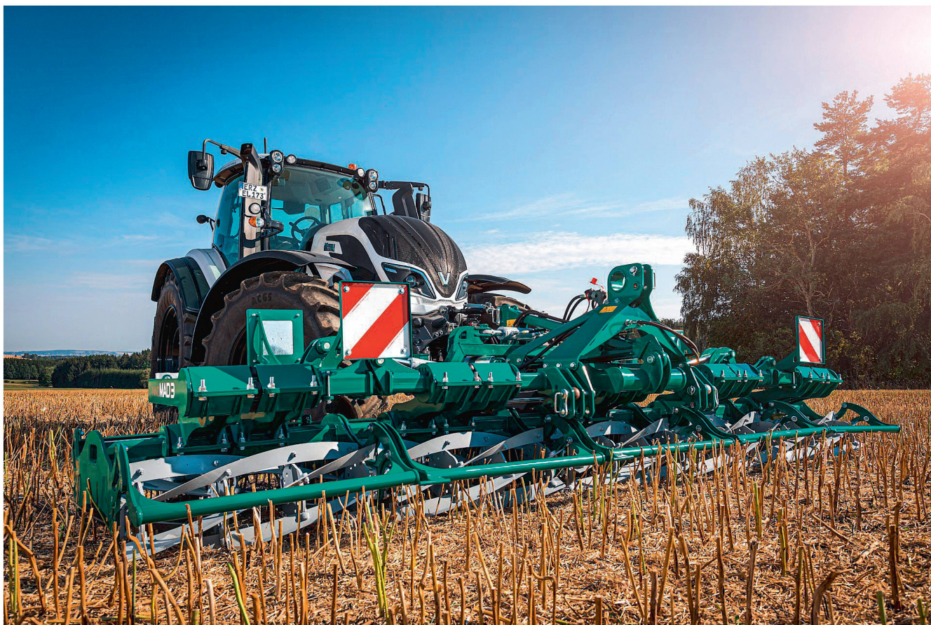
Eidam verwendet gegenläufig gewendelte Messer, die durch entgegengesetzte Verdrehung einen Kreuzschnitt erzielen. Bild: Eidam
