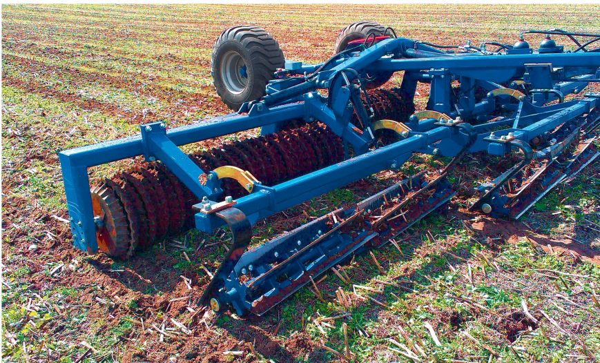
Dalbo teilt die vorlaufenden Messerwalzen in einzelne und versetzte Elemente auf. Bild: Dalbo
