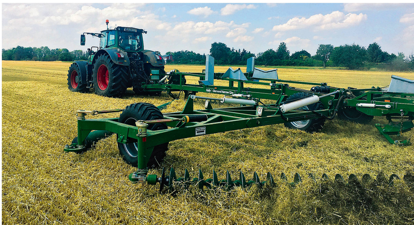
Niemals zu tief: Die Kettenscheibenegge ist ein ideales Gerät für die flache, aber leistungsfähige Stoppelbearbeitung. Bild: Eilbote
