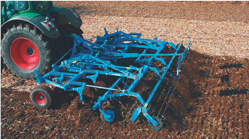
Geeignete Einebnungs- und Randwerkzeuge hinterlassen eine ebene Oberfläche ohne Dämme oder Furchen. Bild: Lemken
