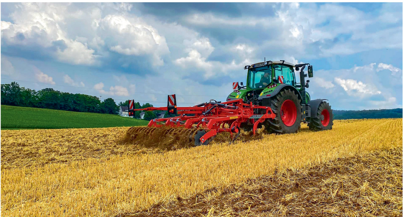
Damit ein Grubber gut arbeitet, ist ein schräges Fahren von mindestens zehn Grad zur Särichtung empfehlenswert. Bild: Kverneland
