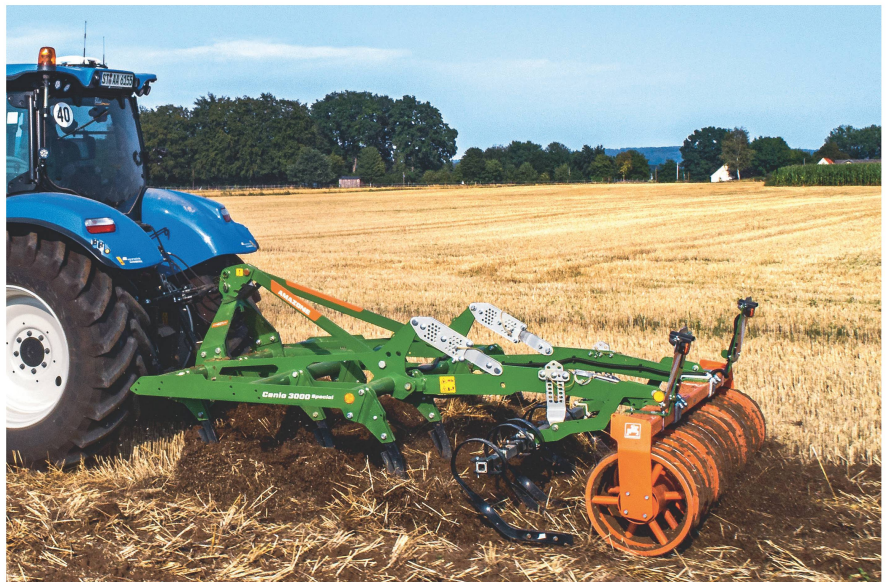
Die zahlreichen Einstellmöglichkeiten eines modernen Grubbers sollten in der Praxis auch genutzt werden. Bild: Amazone
