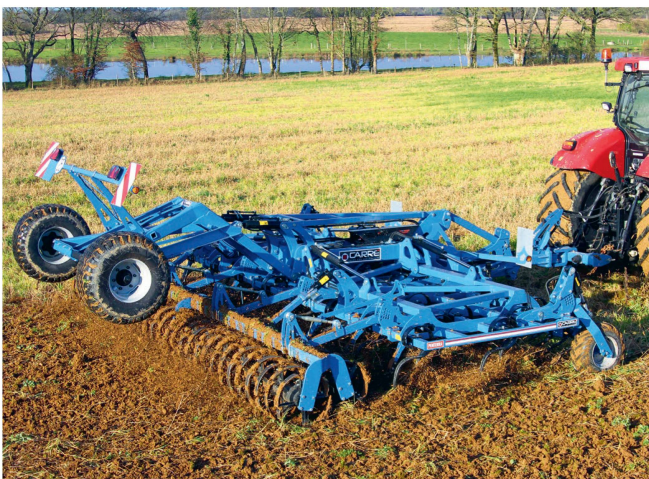
Beispiel Flachgrubber oder Federzinkenegge: Je geringer der Strichabstand, desto flacher die Bearbeitung. Bild: Carré
