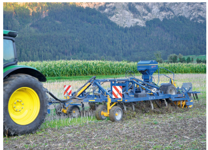
Ein gezogenes Gerät mit vorlaufendem Fahrwerk und tragender Walze arbeitet sehr gleichmässig flach. Bild: R. Hunger
