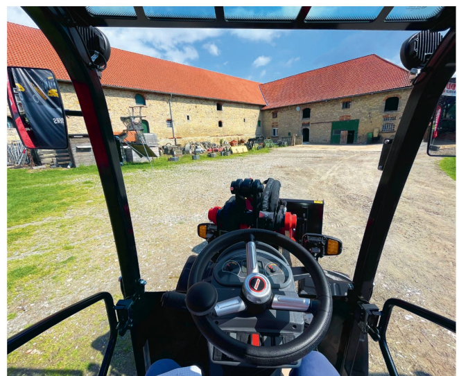
Das 4-Pfosten-Fahrerschutzdach bietet eine hervorragende Sicht auf das Arbeitsumfeld.
