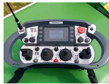
Beim An- und Abkuppeln oder bei unvorhergesehenen Eingriffen kann der Bediener das Triebfahrzeug manuell mit einer Fernbedienung oder über eine mobile App steuern.
