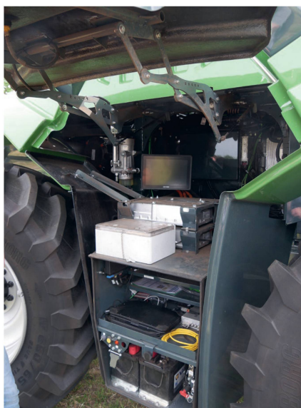
Dieses Modell des «VTE» ist mit 20 elektronischen Steuereinheiten ausgestattet.
