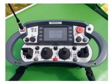
Beim An- und Abkuppeln oder bei unvorhergesehenen Eingriffen kann der Bediener das Triebfahrzeug manuell mit einer Fernbedienung oder über eine mobile App steuern.
