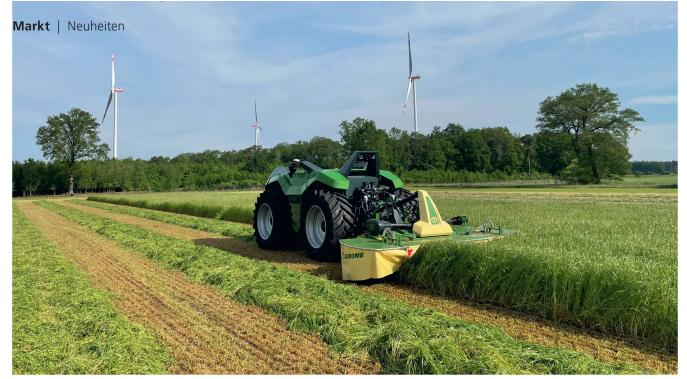
Der von Krone und Lemken entwickelte autonome Werkzeugträger «VTE» wird von einem 230 PS starken Dieselmotor angetrieben und verfügt über einen konventionellen 3-Punkt-Heckkraftheber. Bilder: M. Schubnel
