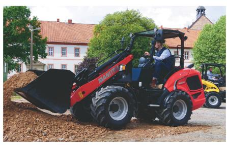
Als grösstes Modell der neuen Baureihe hebt der «MLA 5-50 H» 1880 kg mit der Schaufel. Die Hubhöhe beträgt 3,07 m.
