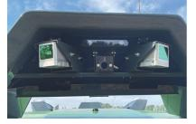
Auf der Vorder- und der Rückseite befinden sich jeweils eine Stereokamera, zwei Lidars und eine konventionelle Kamera.
