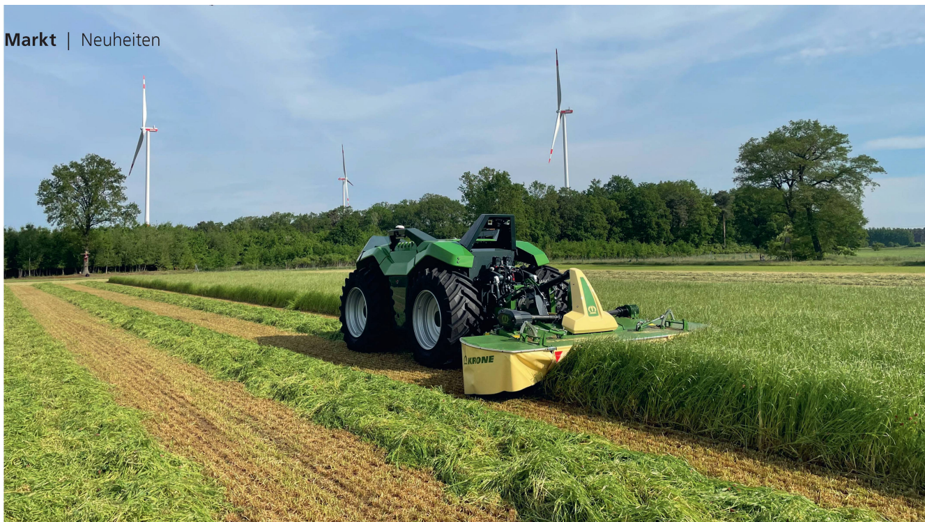
Der von Krone und Lemken entwickelte autonome Werkzeugträger «VTE» wird von einem 230 PS starken Dieselmotor angetrieben und verfügt über einen konventionellen 3-Punkt-Heckkraftheber. Bilder: M. Schubnel
