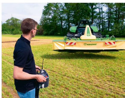
Beim An- und Abkuppeln oder bei unvorhergesehenen Eingriffen kann der Bediener das Triebfahrzeug manuell mit einer Fernbedienung oder über eine mobile App steuern.
