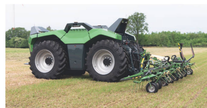
Ausgestattet mit einem 8,20 m breiten Kreiselheuer hat dieser «VTE» ohne menschlichen Eingriff das Gras einer frisch gemähten Parzelle gewendet.
