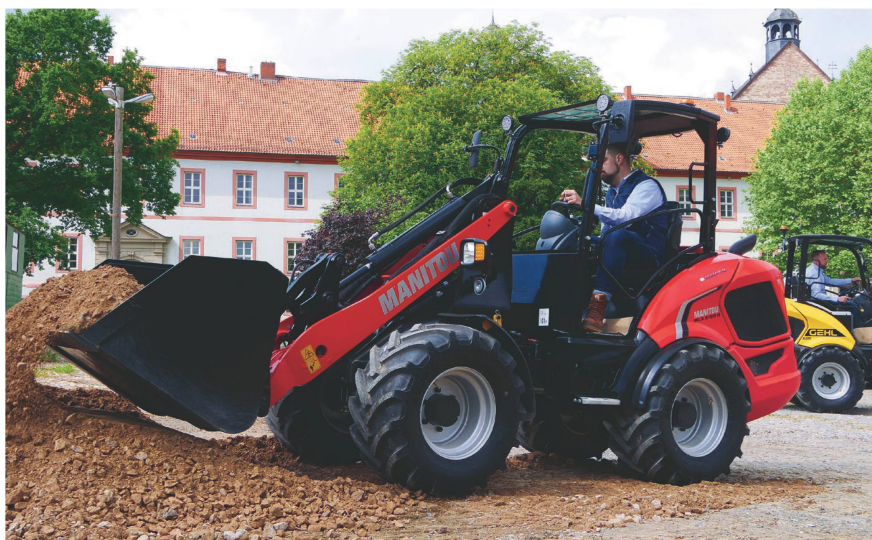
Als grösstes Modell der neuen Baureihe hebt der «MLA 5-50 H» 1880 kg mit der Schaufel. Die Hubhöhe beträgt 3,07 m.
