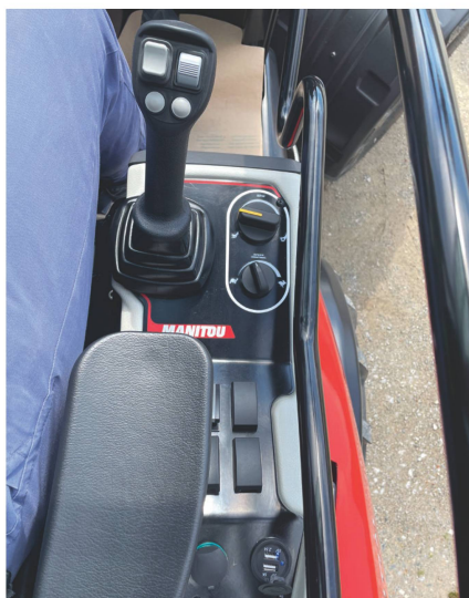
Blick auf die rechte Konsole mit dem multifunktionalen Joystick.
