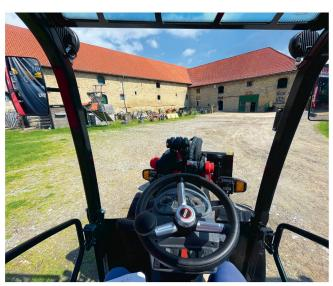
Das 4-Pfosten-Fahrerschutzdach bietet eine hervorragende Sicht auf das Arbeitsumfeld.
