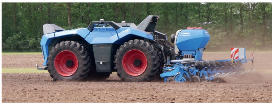
Der «VTE» von Lemken in blauer Farbe ist hier mit einer 8-reihigen Einzelkorn-Sämaschine vom Typ «Azurit 10» unterwegs.
