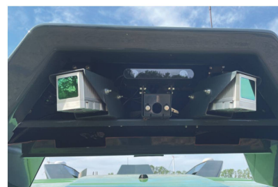
Auf der Vorder- und der Rückseite befinden sich jeweils eine Stereokamera, zwei Lidars und eine konventionelle Kamera.
