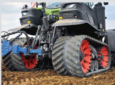
Claas kann heuer auf 35 Jahre Erfahrung mit den Raupenlaufwerken vom Typ «Terra Trac» blicken, die zudem seit einem Vierteljahrhundert in eigenem Hause, nämlich bei Claas Industrietechnik in Paderborn, gefertigt werden. Claas nutzt diese Jubiläen, um weitere Initiativen in diesem Segment anzukündigen. So wird das selbstlernende, interaktive Fahrerassistenz- und Prozessoptimie-
