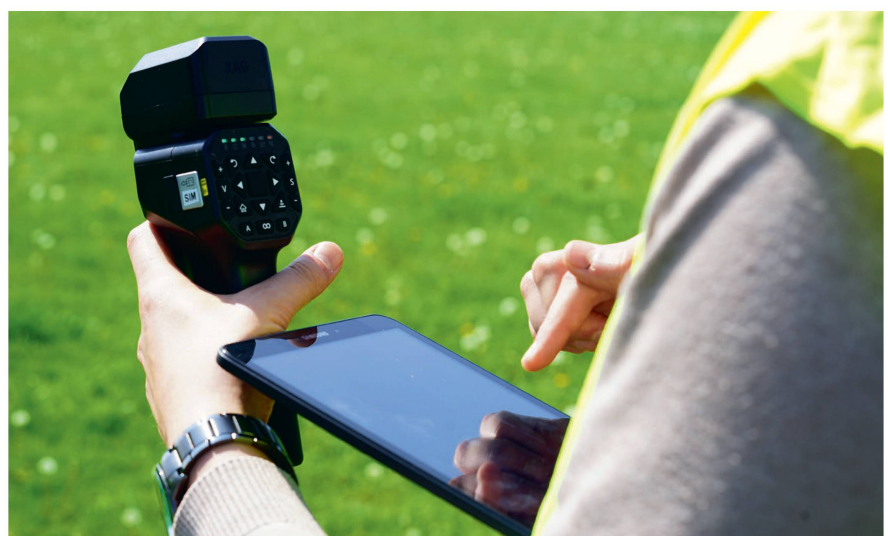
Mittels Tablet und Kontroll-Stick wird der komplette automatische Sprühvorgang für eine definierte Parzelle berechnet und eingeleitet.
