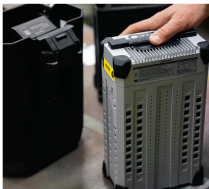
Das Aufladen einer Batterie dauert nur elf Minuten, denn sie kommt in ein Wasserbad (links) zu stehen und kann deshalb nicht überhitzen.
