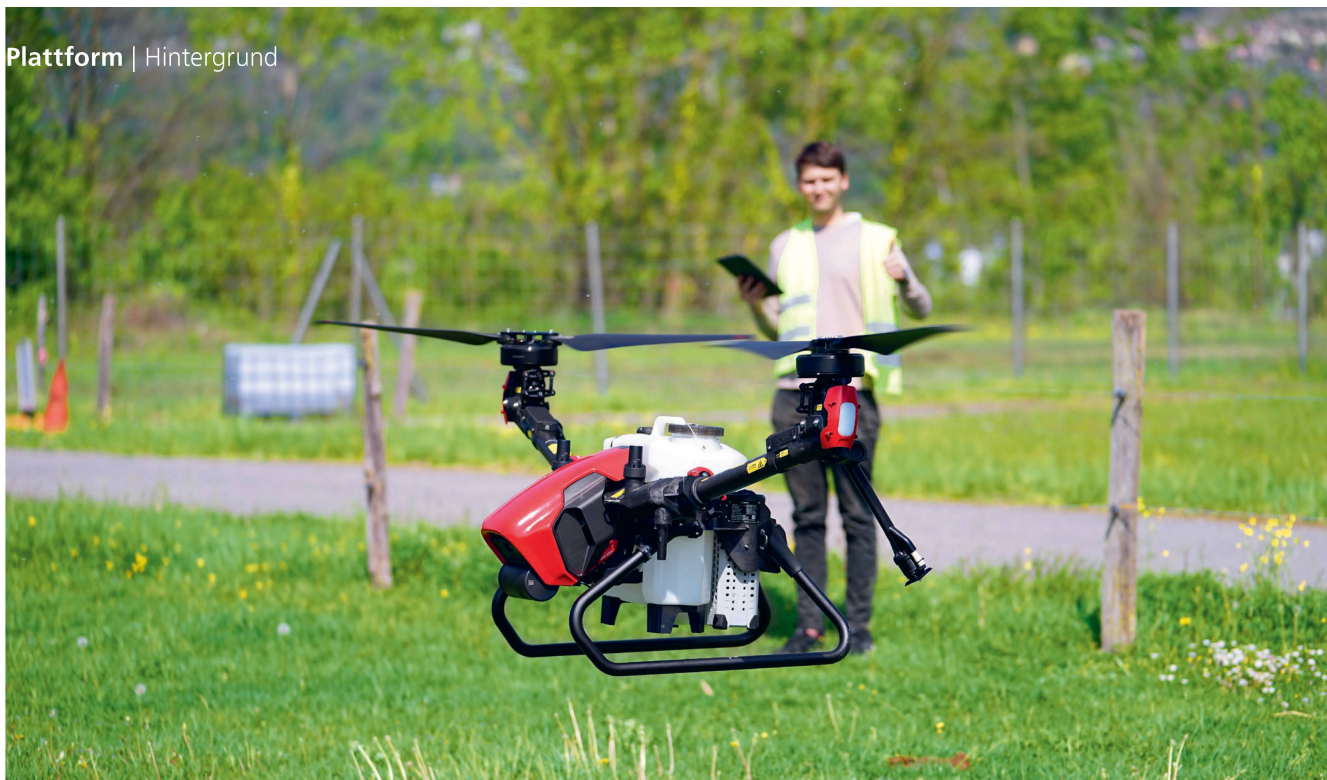
Drohnenpilot Thomas Calvi startet den autonomen Sprüheinsatz der Doppelrotor-Landwirtschaftsdrohne «V40» mit dem 18-Liter-Kanister und dem Akku (rechts unten). Bilder zVg/D. Senn
