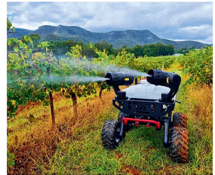
Der «Rover 150» ist schlicht nichts anderes als die Bodenvariante der «V40», ausgestattet mit dem «JetSprayer»-System; er dient auch als Lastentransportmittel.
