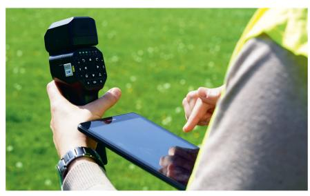
Mittels Tablet und Kontroll-Stick wird der komplette automatische Sprühvorgang für eine definierte Parzelle berechnet und eingeleitet.
