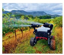
Der «Rover 150» ist schlicht nichts anderes als die Bodenvariante der «V40», ausgestattet mit dem «JetSprayer»-System; er dient auch als Lastentransportmittel.
