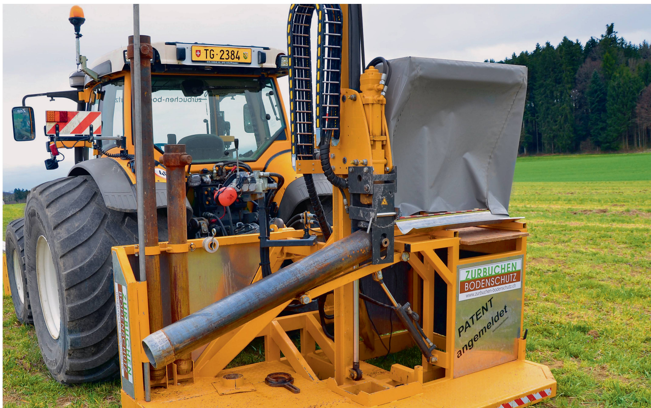
Der eigens konstruierte Bodenprofilstecher war unter anderem im Auftrag der Fachhochschule HAFL für ein Forschungsprojekt im Kanton Bern unterwegs. Bilder: R. Hunger
