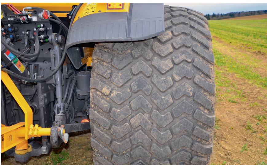
Bodenschonende Bereifung steht ganz oben auf der Prioritätenliste. So werden maximale Bodendruckwerte von 0,85 bar (beladen) bzw. 0,40 bar (leer) erreicht.
