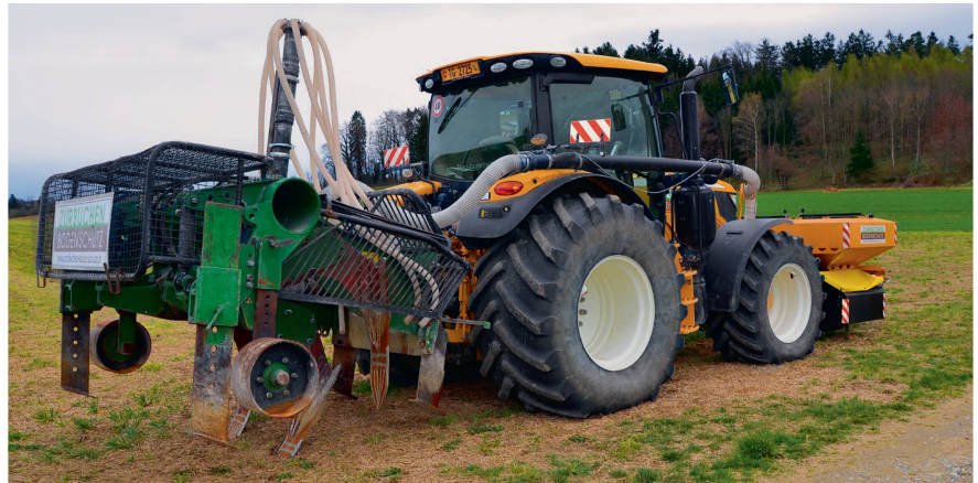
Wenn notwendig werden Bodenschichten mit Tiefrotationsspaten-Maschinen über 1 m tief gemischt und bei Bedarf können gezielt flüssige oder feste Hilfsstoffe eingearbeitet werden.
