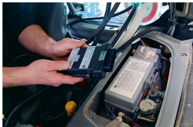
«Green Fit» ist für jede Fahrzeugplattform individuell konzipiert – die entsprechenden Fahrzeugparameter werden fest in der Software verankert.
