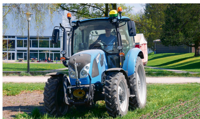
Dieser Traktor verfügt nun über die vollen Funktionalitäten von Isobus sowie «AutoTrac».
