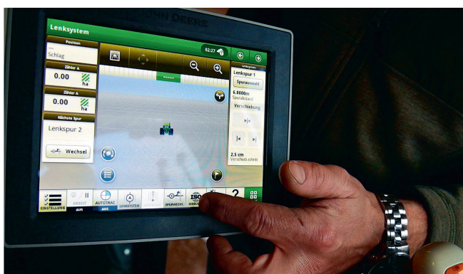
In der Kabine wird die Halterung für das «GreenStar»-Display angebracht und das Terminal platziert.
