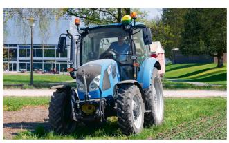
Dieser Traktor verfügt nun über die vollen Funktionalitäten von Isobus sowie «AutoTrac».
