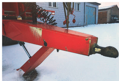
Deutliche Spuren von Kollisionen der Reifen mit der Deichsel. Die Kopfplatte der Deichsel ist durch Kollision mit dem Anhängelock beschädigt.
