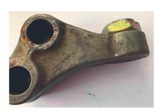
Durch Kollision beim Ankuppeln ist der Niederhalter aufgebogen und zeigt Haarrisse. Das Schadbild ist herstellerunabhängig.
