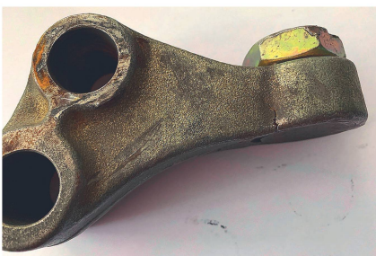
Durch Kollision beim Ankuppeln ist der Niederhalter aufgebogen und zeigt Haarrisse. Das Schadbild ist herstellerunabhängig.
