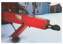
Deutliche Spuren von Kollisionen der Reifen mit der Deichsel. Die Kopfplatte der Deichsel ist durch Kollision mit dem Anhängebock beschädigt.
