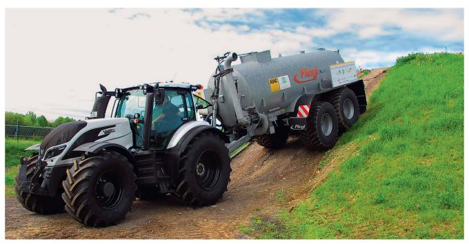
Das Walterscheid-Kugelsystem lässt beim Befahren von Böschungen einen vertikalen Bewegungswinkel von 36 Grad zu. Bilder: Walterscheid
